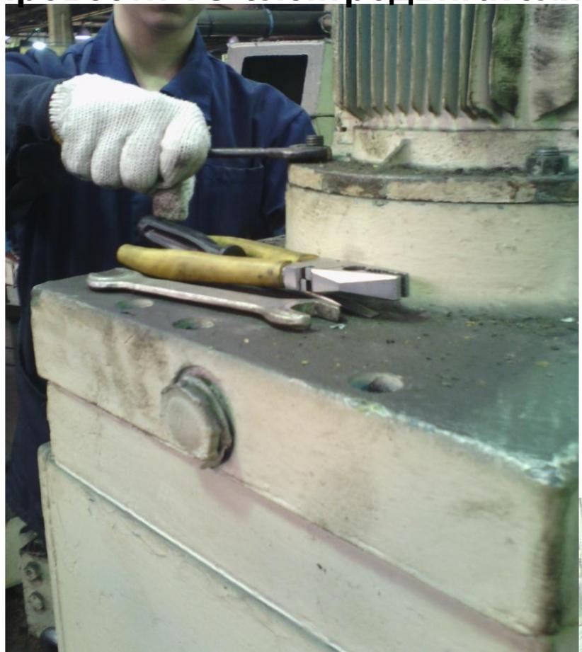
**Проверить крепление электродвигателя к фланцу, затянув болты ключом гаечным 19х22.**
