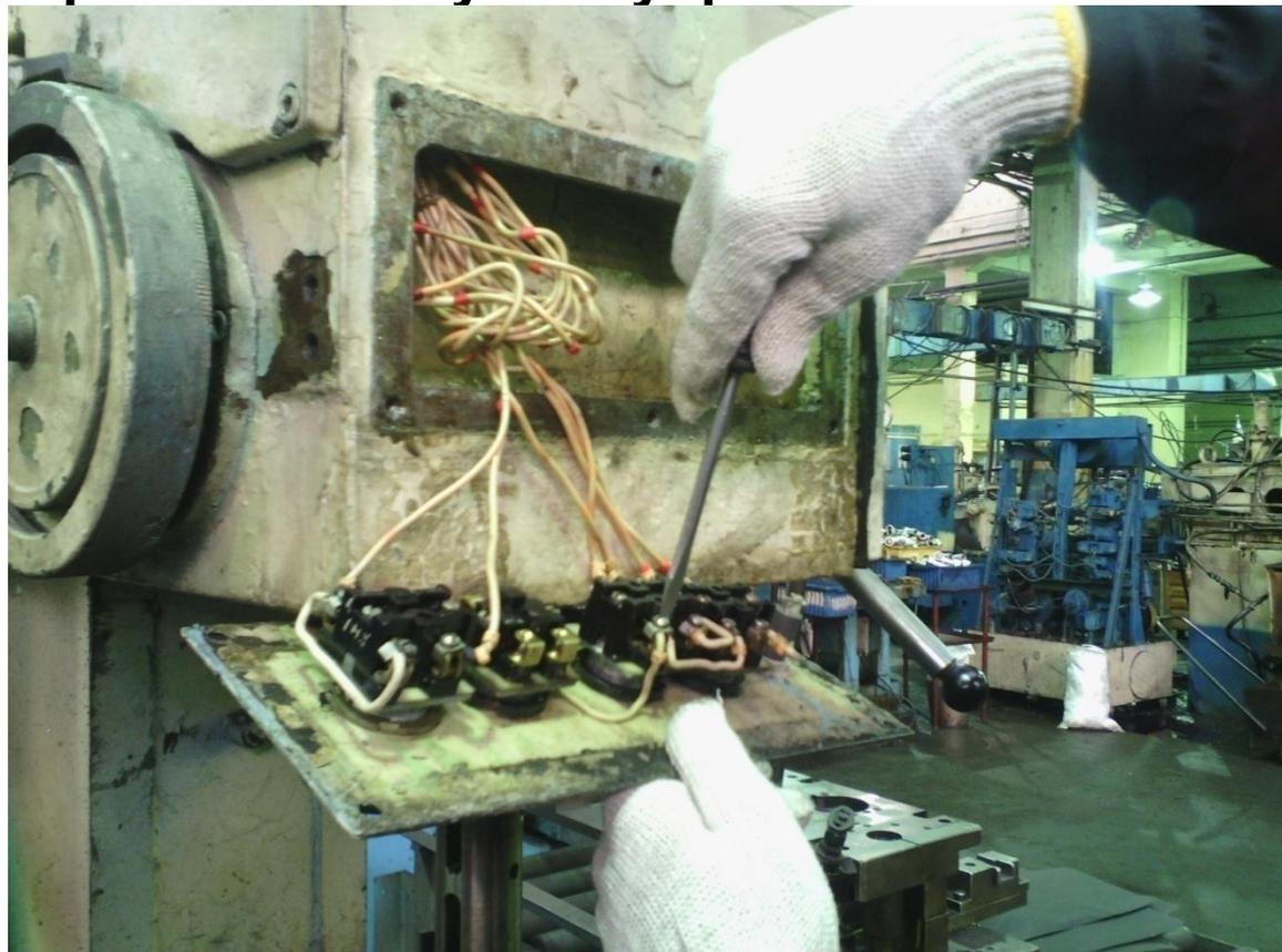
**Используя электромонтажный инструмент протянуть контакты.**
