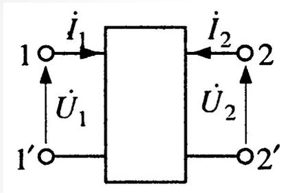
Согласно свойству аддитивности (принципу наложения) токи  $\dot{I}_1$  и  $\dot{I}_2$  можно записать в следующем виде:
