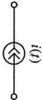
*Источником тока* (независимым) называют двухполюсный идеализированный элемент, электрический ток которого не зависит от напряжения на его зажимах.
