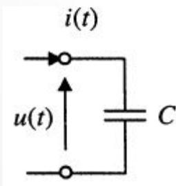
*Емкость* обладает только свойством накопления энергии электрического поля
