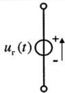
*Источником напряжения* (независимым) называют двухполюсный идеализированный элемент, напряжение на зажимах которого не зависит от свойств цепи являющейся внешней по отношению к нему.
