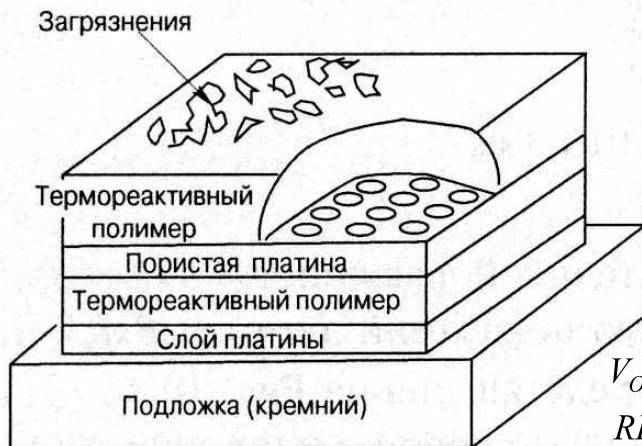
Конструкция емкостного датчика относительной влажности ННН-3610
