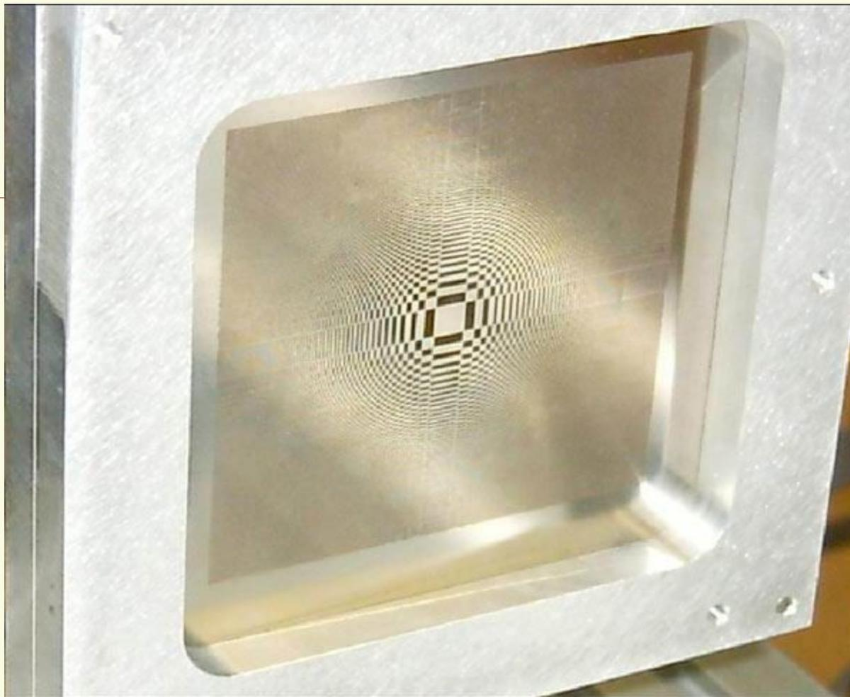
Зонная пластинка Френеля–Соре с успехом применяется в оптике с конца XIX, но пластинка, которой должен быть оснащен телескоп Кёклена имеет свои особенности: чередующиеся прозрачные и непрозрачные отверстия в ней имеют не кольцевую, а строго прямоугольную форму.
