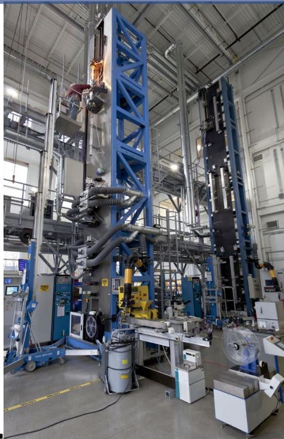
Затем из сердцевины горячей заготовки с помощью вытягивания получают тонкую стеклянную нить, которую сразу же покрывают несколькими оболочками (определенные полимеры, которые на волокне полимеризуются), предотвращающими образование трещин на поверхности
