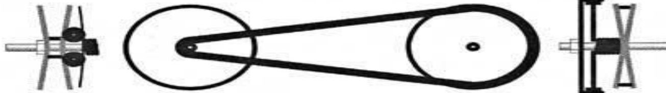
Низшее передаточное отношение, сцепление включено
