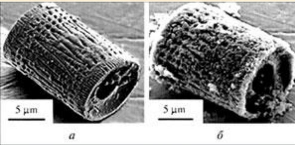
**Созданная из анатаза  $\text{TiO}_2$  структура (а), повторяющая скелет водоросли (б)**
