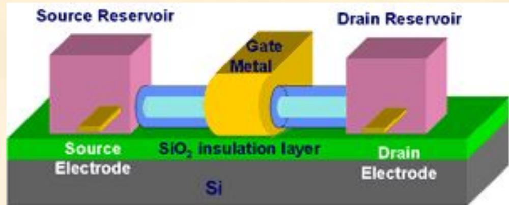
Схема «наножидкостного» транзистора. Поток ионов в жидкости внутри нанотрубки (синего цвета) прекращается при подаче напряжения на вентиль (желтого цвета). Изображение с сайта [www.berkeley.edu](http://www.berkeley.edu)
