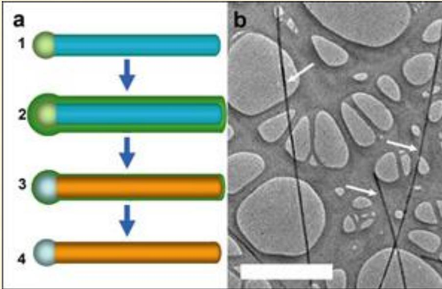
Слева: кремниевая нанопроволока покрывается никелем, затем нагревается, чтобы сформировалась связь, затем излишки никеля убираются. Справа: сделанный электронным микроскопом снимок нанопроволоки (показана стрелочками) диаметром в поперечнике 20 нанометров, или 200 атомов (изображение с сайта [www.harvard.edu](http://www.harvard.edu))
