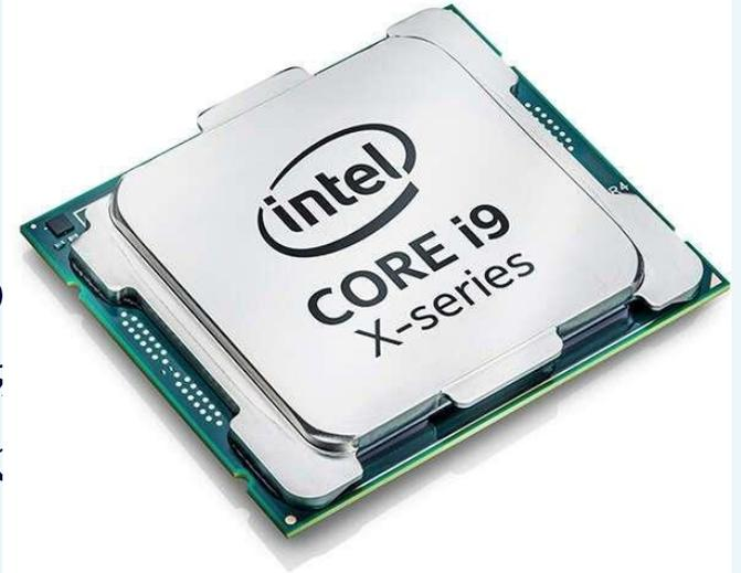
Центральный процессор — электронный блок либо интегральная схема, исполняющая машинные инструкции (код программ), главная часть аппаратного обеспечения компьютера или программируемого логического контроллера.
