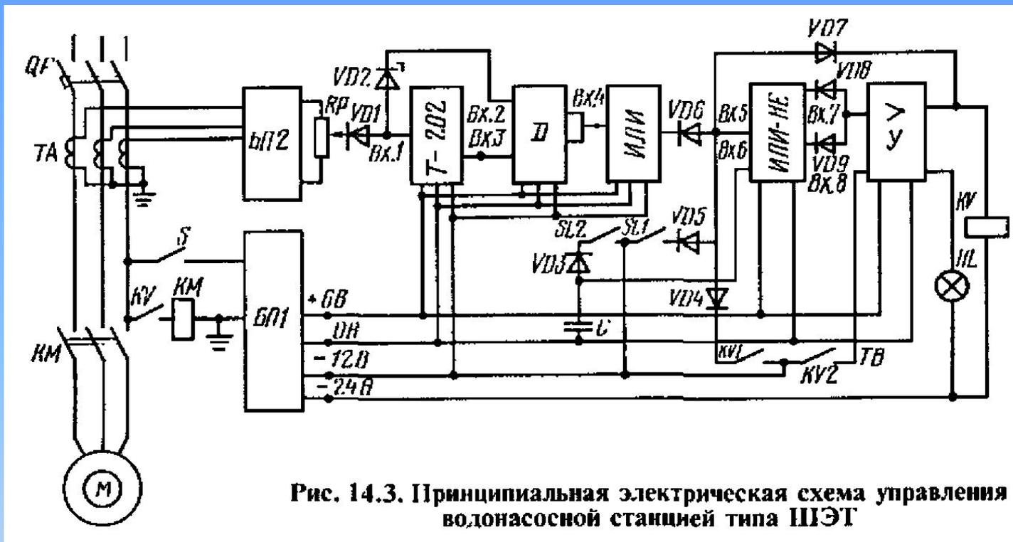
Рис. 14.3. Принципиальная электрическая схема управления водонасосной станцией типа ШЭТ
