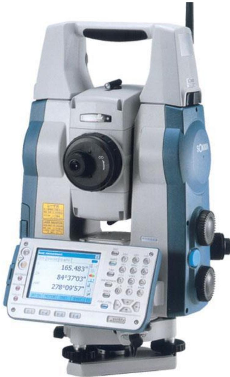
Точность измерения углов - 5" (отсчёты берутся по диаметрально противоположным сторонам вертикального и горизонтального кодовых дисков), увеличение - 30<sup>x</sup>, дальность измерения расстояния без отражателя/с отражателем – 500/5000 м, точность измерения расстояния без отражателя/с отражателем –  $(3+2 \times 10^{-6}D)/(2+2 \times 10^{-6}D)$ , клавиатура – 32 клавиши + цветной сенсорный дисплей.
