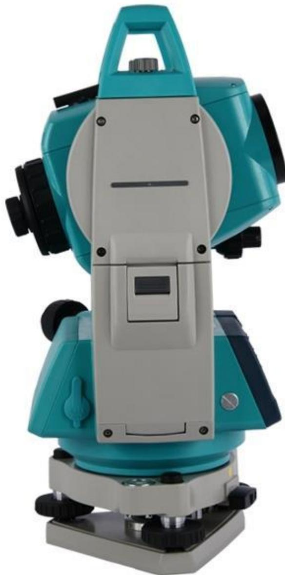
Точность измерения углов - 6" (отсчёты берутся по диаметрально противоположным сторонам вертикального и горизонтального кодовых дисков), увеличение - 26<sup>x</sup>, компенсатор двухосевой, дальность измерения расстояния без отражателя/с отражателем – 350/5000 м, точность измерения расстояния без отражателя/с отражателем –  $(3+2 \times 10^{-6}D)/(2+2 \times 10^{-6}D)$ , клавиатура – 27 клавиш на каждой стороне (SET630RK- односторонний) + двусторонний дисплей.
