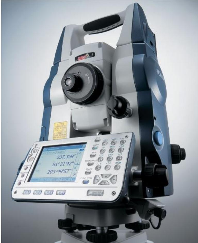
Точность измерения углов - 2" (отсчёты берутся по диаметрально противоположным сторонам вертикального и горизонтального кодовых дисков), увеличение - 30<sup>x</sup>, компенсатор двухосевой, дальность измерения расстояния без отражателя/с отражателем – 500/5000 м, точность измерения расстояния без отражателя/с отражателем –  $(3+2 \times 10^{-6}D)/(2+2 \times 10^{-6}D)$ , клавиатура – 32 клавиши + цветной сенсорный дисплей.
