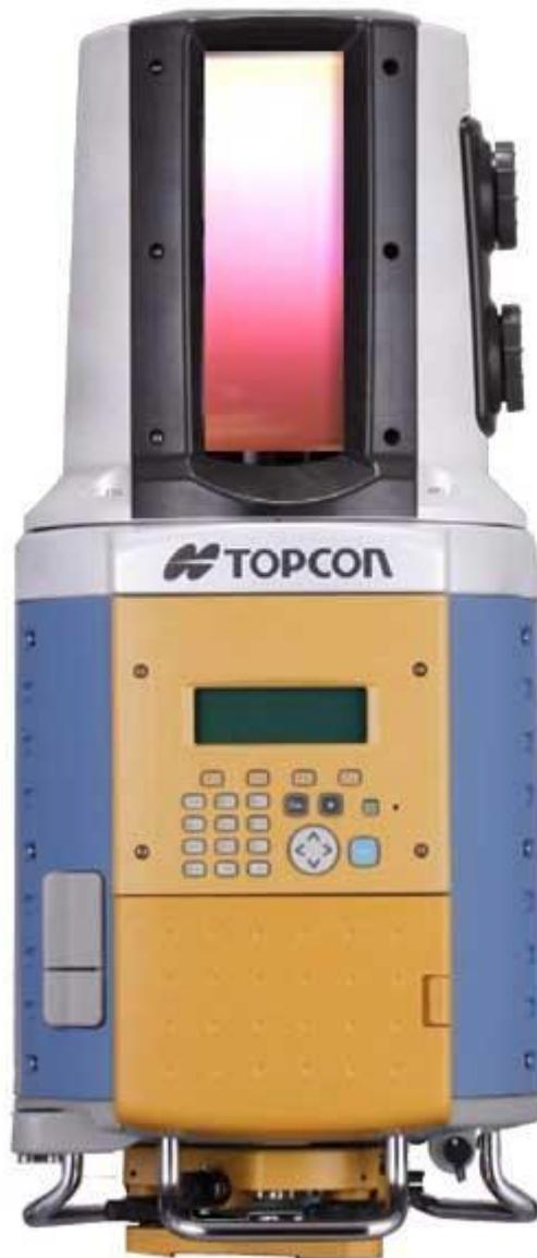
Одной из последних моделей лазерных сканеров является Topcon GLS-1000. Это импульсный лазерный сканер, созданный для автономной работы (он не требует использования компьютера, внешних аккумуляторов и проводов). Измеряемое расстояние – до 330 м (при отражающей способности цели 90%), точность измерения расстояний – 4 мм/ 150м, угловая точность – 6", скорость сканирования – 3000 точек в секунду, плотность сканирования – 1 мм между точками на 100 м.
