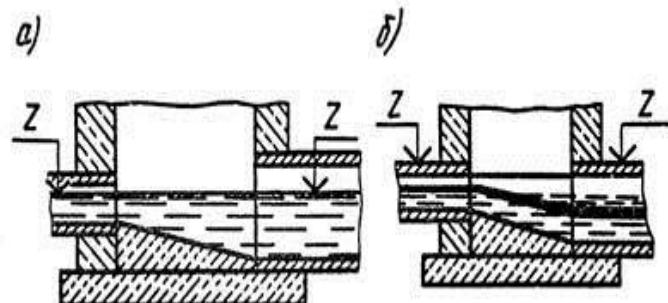
Рис.10.7. Соединение труб в колодцах:
