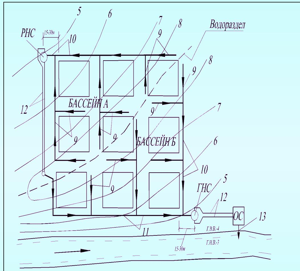
**Рис. 2.7 – Общая схема водоотведения населенного пункта:**
