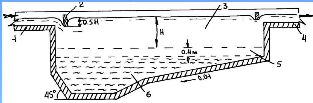
1 – подводящий поток (труба); 2 – полупогруженная перегородка; 3 – проточная часть; 4 – отводящий лоток; 5 – нейтральный слой; 6 – иловая часть
