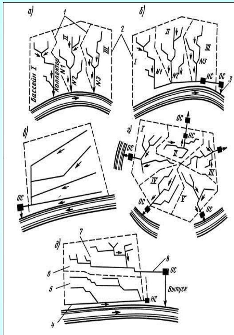
Рис. 2. Схемы канализационных сетей населенных пунктов:
