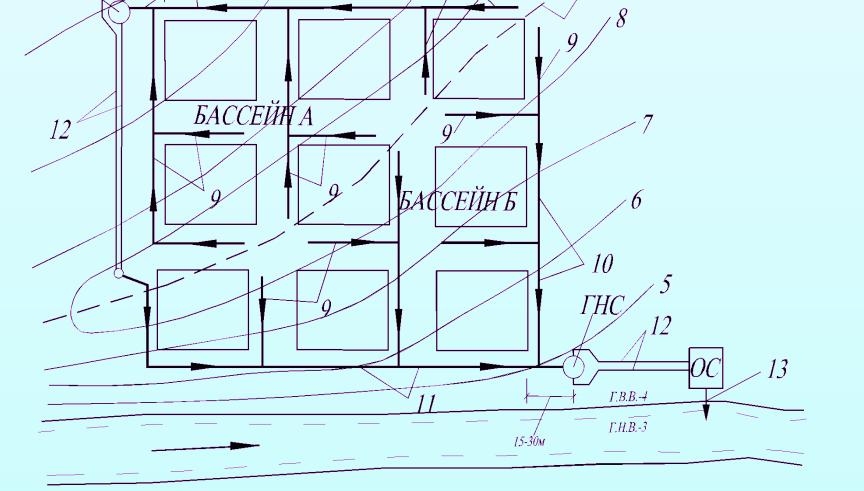
Рис. 2.6 – Схема внутридворовой водоотводящей сети:
