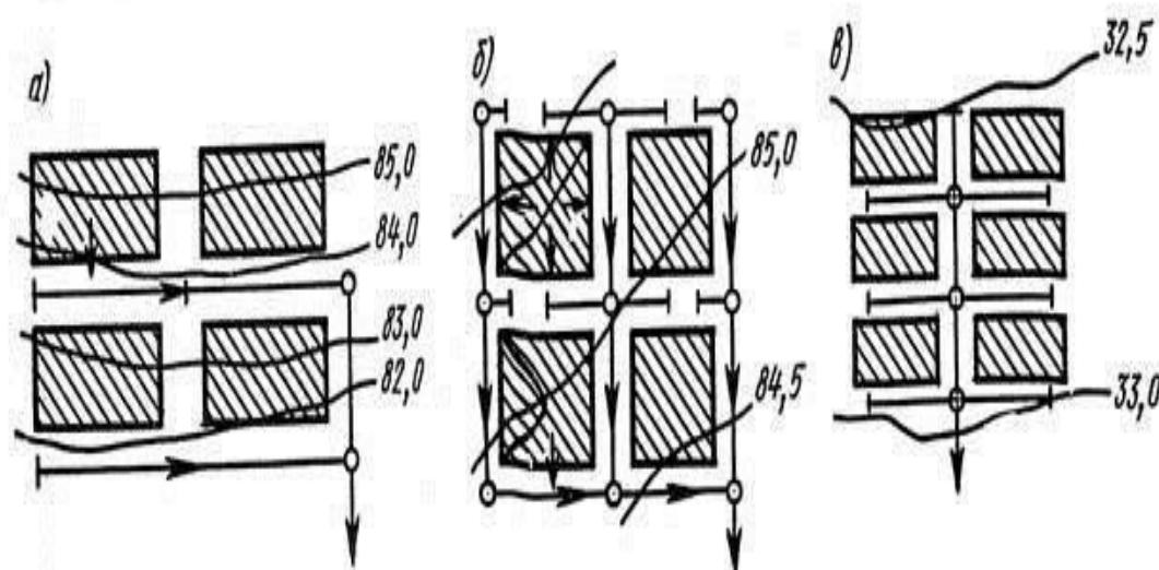
Рис. 1. Схемы трассировки канализационных сетей
