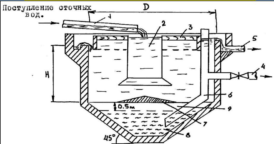
1 – подводящая труба; 2 – камера реакции;
