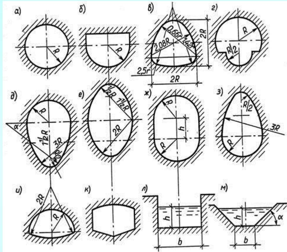
Рис.10.2. Поперечное сечение труб и каналов:
