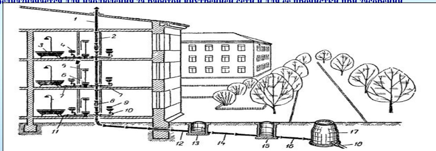
Рис. 1.1. Схема внутренней канализации
