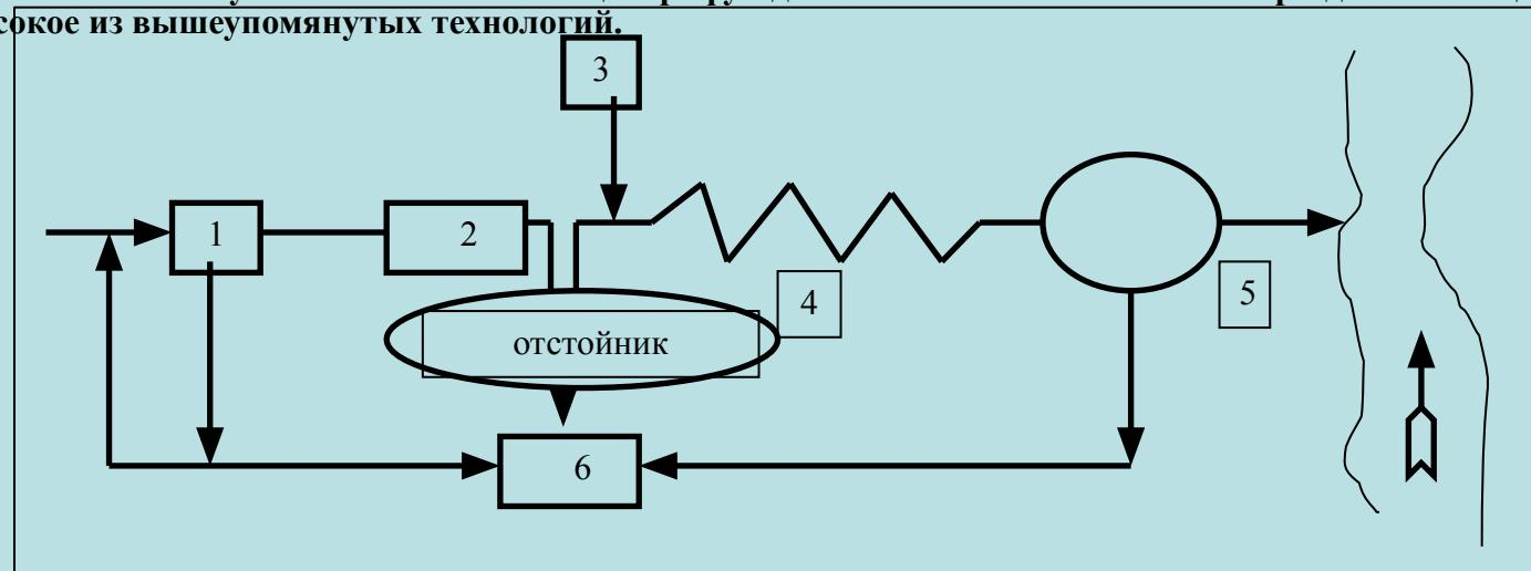
Рис.15. Технологическая схема очистной станции с физико-химической очисткой сточных вод
