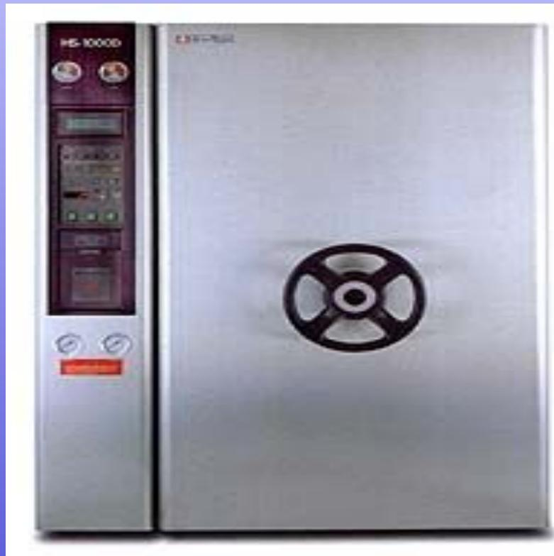
**-затем давление в камере выравнивается с атмосферным; производится охлаждение, как объектов стерилизации, так и самой камеры и выгрузка изделий.**
