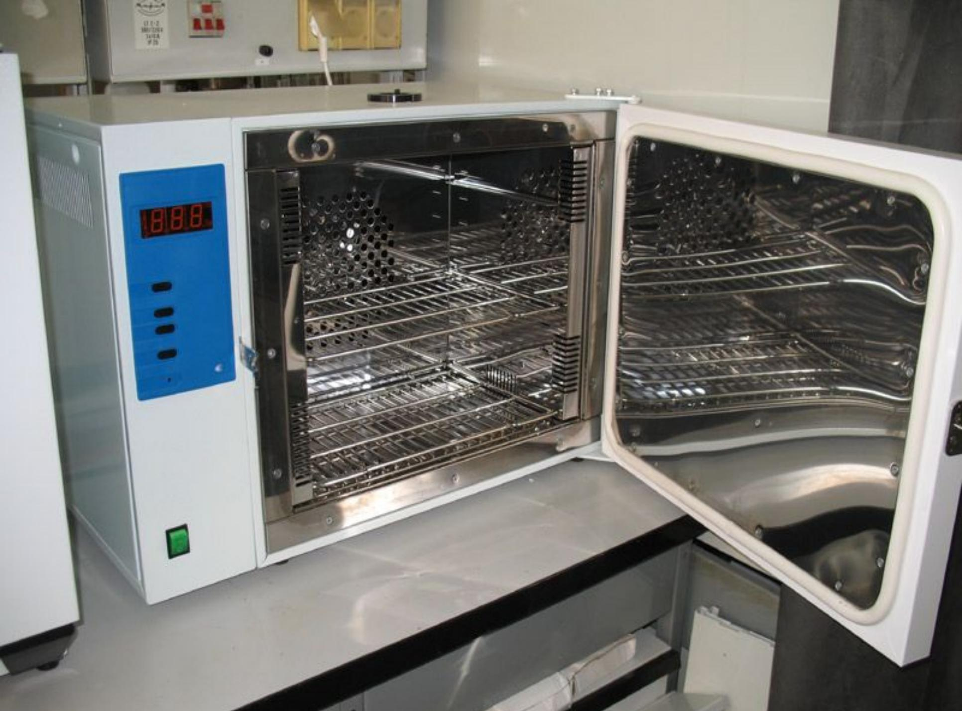
**Не каждый шкаф, способный создать внутри себя температуру 180 °С и выше, может называться воздушным стерилизатором.**
