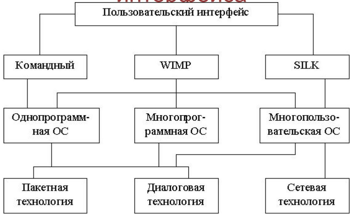
**Командный интерфейс** обеспечивает выдачу на экран системного приглашения для ввода команды.
