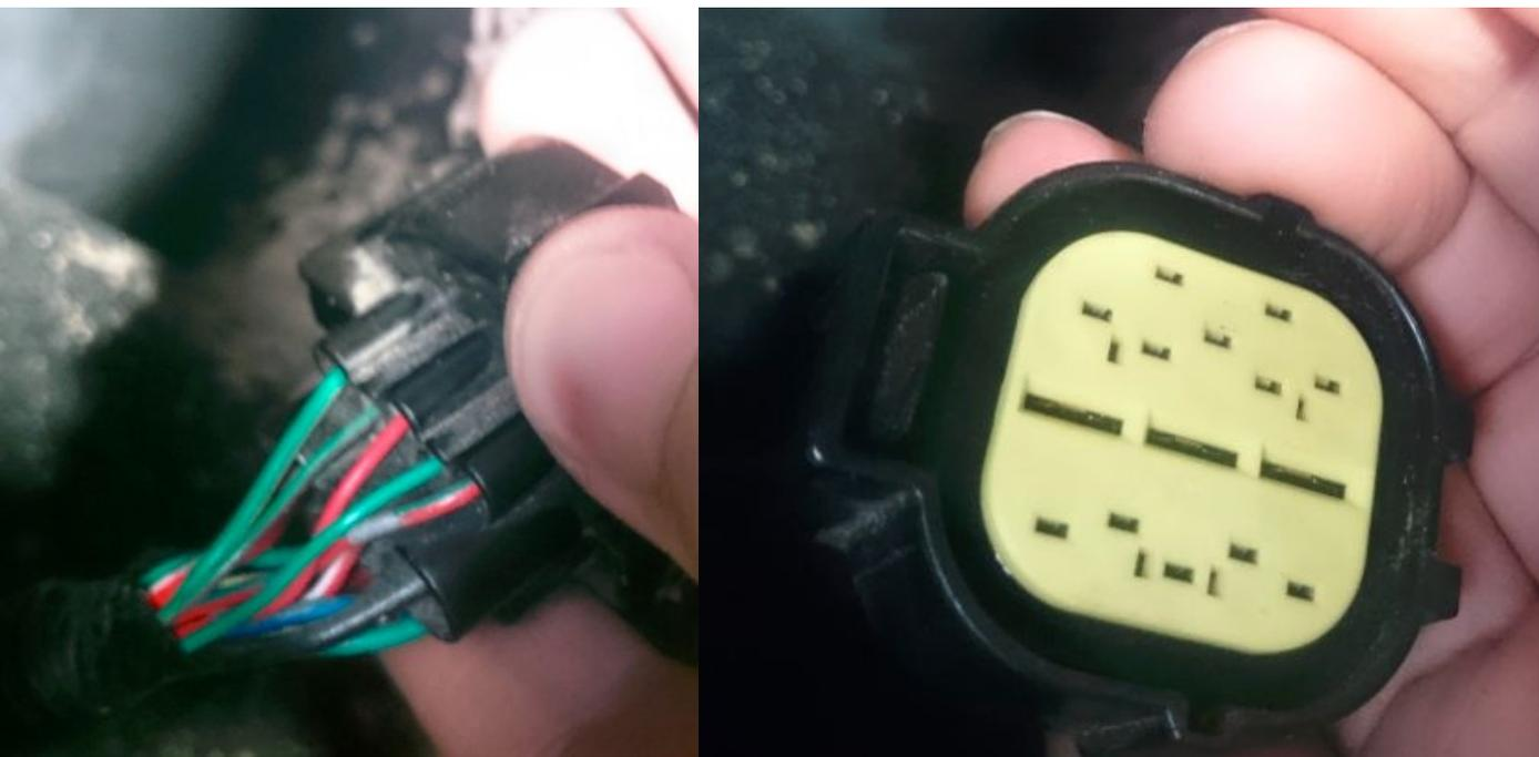
Количество проводов приходящих в разъем указывает на присутствие нужных для установки прицепного устройства (жгут приходящий из кузова авто)
