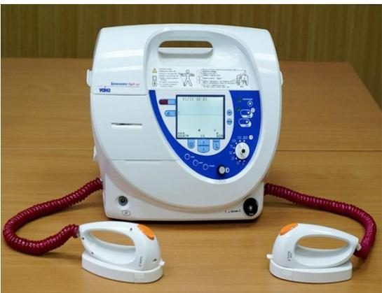
Мощность, потребляемая аппаратом от сети переменного тока ( $220\pm 22$ ) В с частотой 50—60 Гц — не более 200 ВА.
