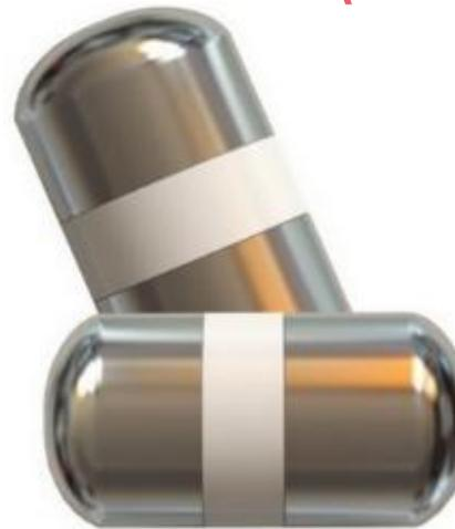
АЭС ЖКТ – электронная капсула диаметром 11 мм и длиной 22 мм, которая при хранении находится в ждущем режиме и автоматически включается при попадании в токопроводящую среду пищеварительного тракта.
