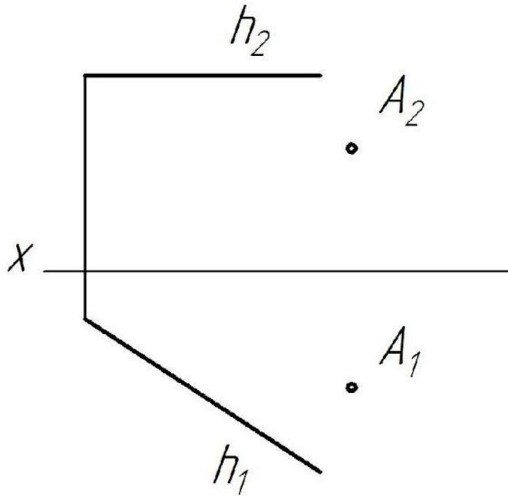
1). По заданному условию параллельности прямых задаем параллельность их проекций.
