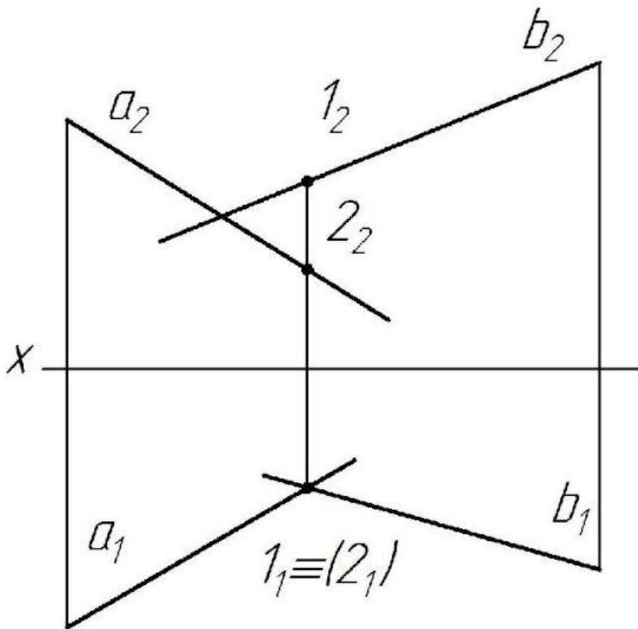
3). Строим проекции фронтально-конкурирующих точек и определяем их **ВИДИМОСТЬ**.
