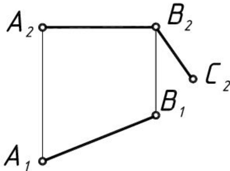
1). Поскольку на плоскости  $\Pi_2$  заданы три вершины прямоугольника, достроим его фронтальную проекцию. Противоположные стороны проекции прямоугольника должны быть параллельны.
