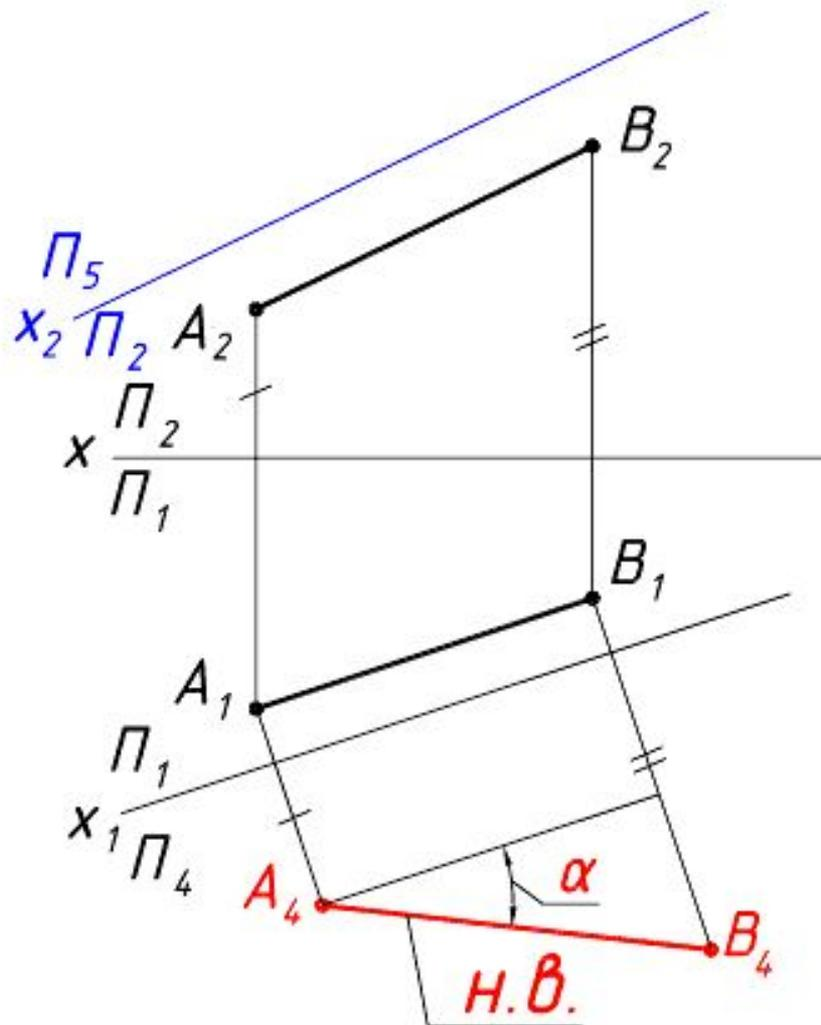
6). Линии связи проводим перпендикулярно  $x_2$  и на них откладываем координаты  $y$ , которые в этом случае сохраняются в плоскости  $\Pi_5$ , новой горизонтальной плоскости проекций.
