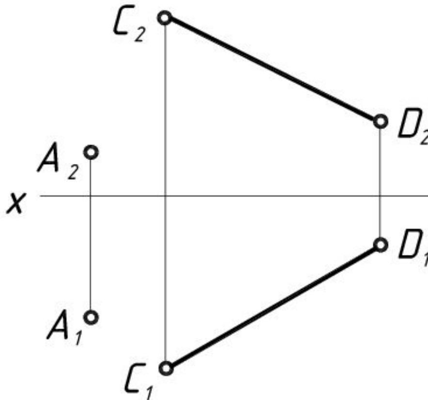
1). Построение необходимо начать с плоскости  $\Pi_1$ , т.к. горизонтальная проекция фронтали параллельна оси  $x$ . Определим точку 1 - пересечение фронтали и прямой  $CD$  на плоскости  $\Pi_1$ .
