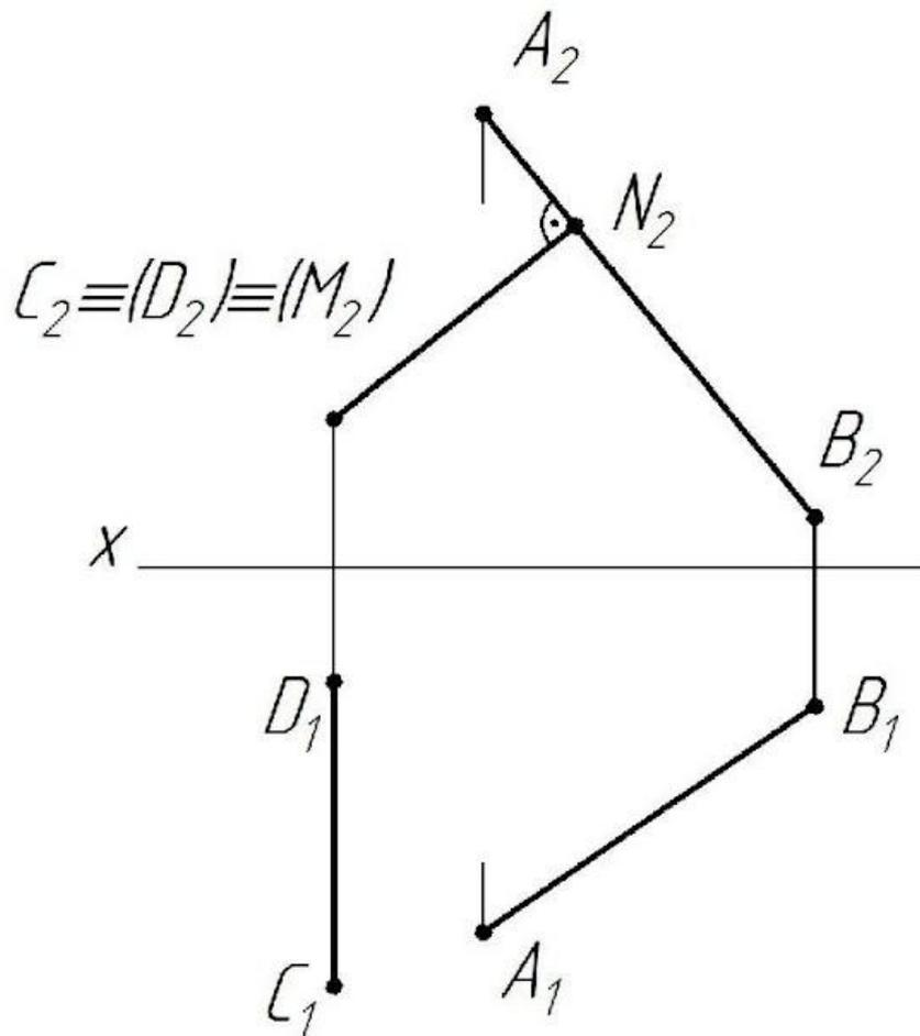
2). Проекция точки пересечения двух прямых  $N$  строим на одной линии проекционной связи.
