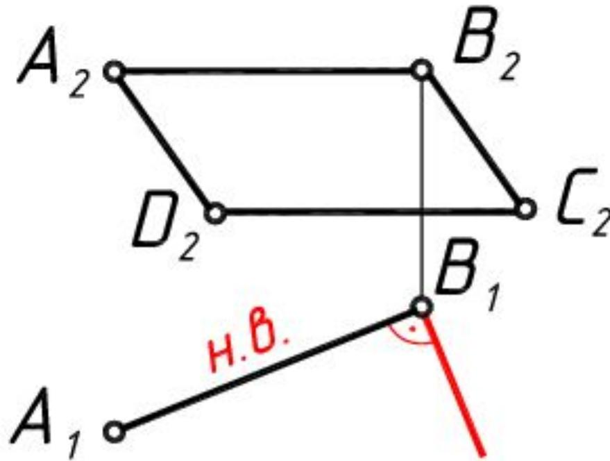
3). Горизонтальную проекцию вершины С строим по линии связи.
