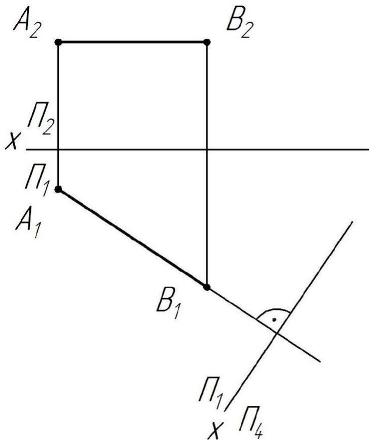
2). В дополнительной плоскости  $\Pi_4$  откладываем координату  $z$  с плоскости  $\Pi_2$ .
