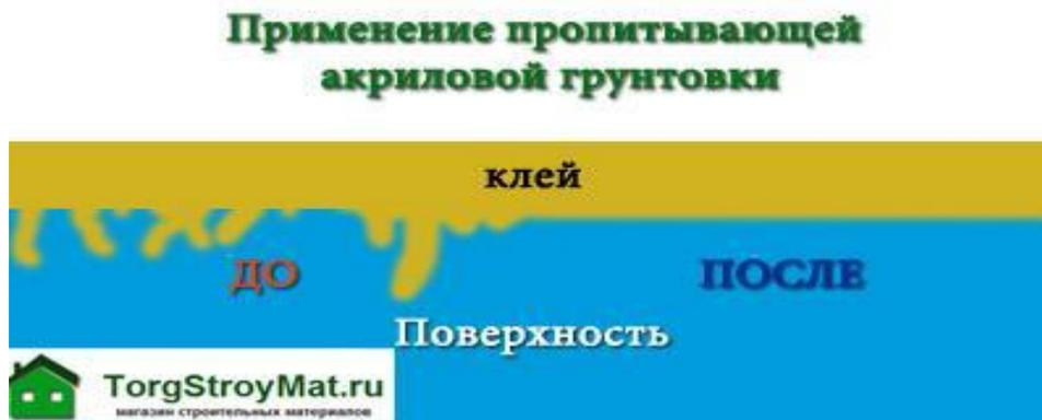
**Грунтовка латексная** предназначена для предварительной обработки поверхности материалов перед шпатлеванием, окраской, наклейкой керамической плиткой, обоев и т.п. для улучшения адгезии, т.е. сцепления наносимого покрытия с обрабатываемой поверхностью новых цементно-бетонных и других материалов, а также для укрепления поверхности старых штукатурок, лакокрасочных покрытий, картона и других пористых материалов.
