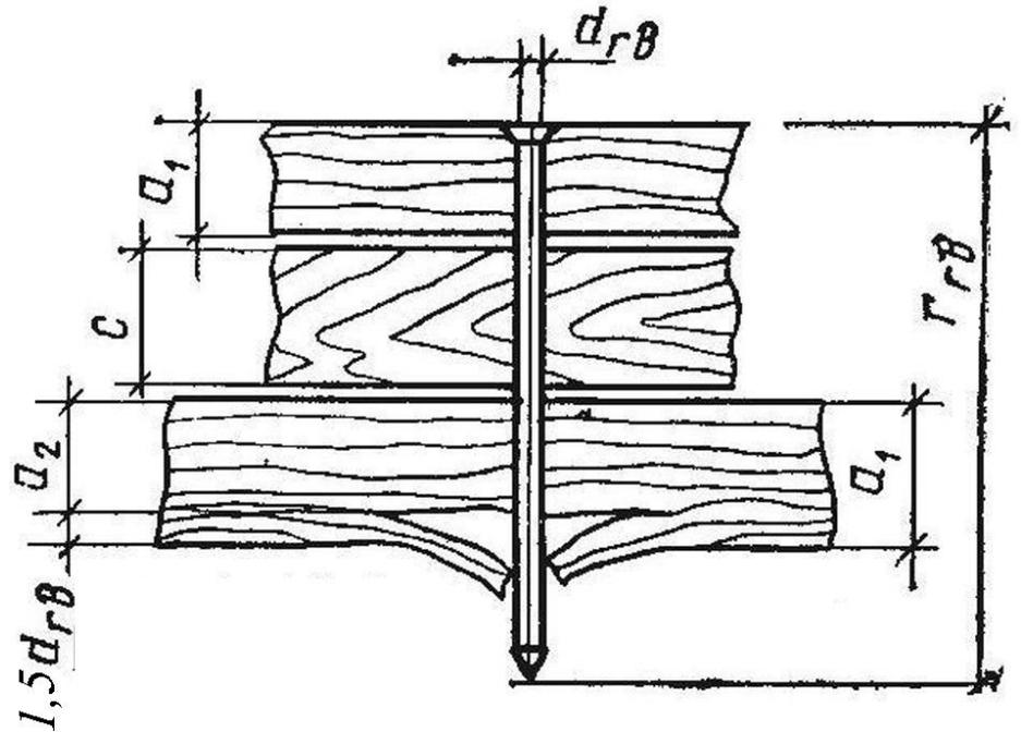
$$a_2 = r_{гв} - a_1 - 2 \text{ мм} - c - 2 \text{ мм} - 1,5d_{гв}$$
