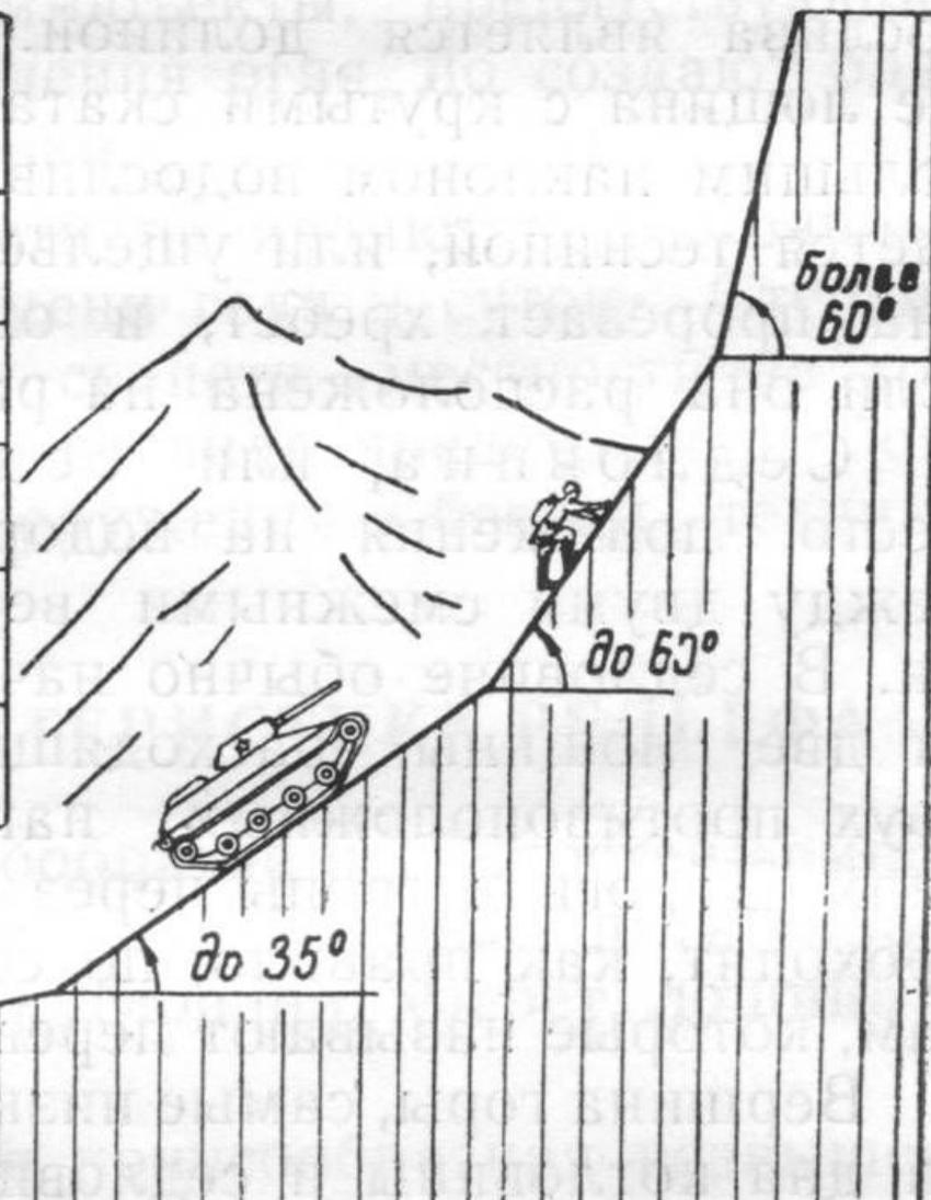
Примечание: При влажности грунта 50% (в обычном состоянии почвы имеют влажность 20%) преодолеваемые уклоны уменьшаются в 2 раза.
