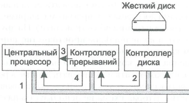
**Этап 1.** Драйвер передает команду контроллеру, записывая информацию в его регистры. Затем контроллер запускает само устройство.
