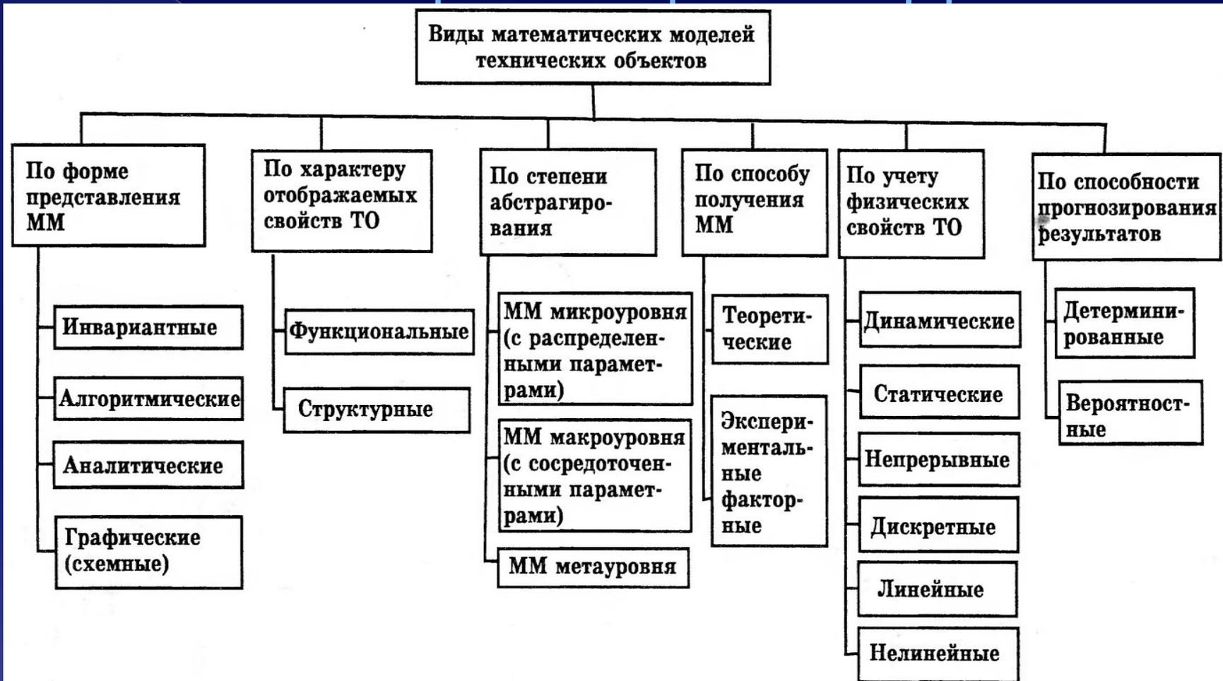
Рис. 1.2. Классификация математических моделей (ТО — технический объект)
