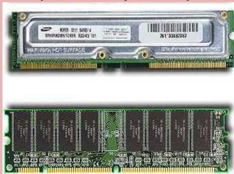
Рис. 2.6. Микросхемы памяти RIMM (сверху) и DIMM (снизу)
