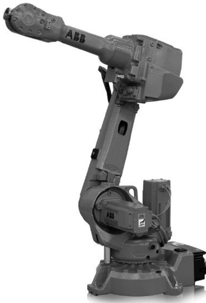
Рис. 9. Новейшая разработка фирмы ABB– много- целевой робот среднего класса IRB 2600
