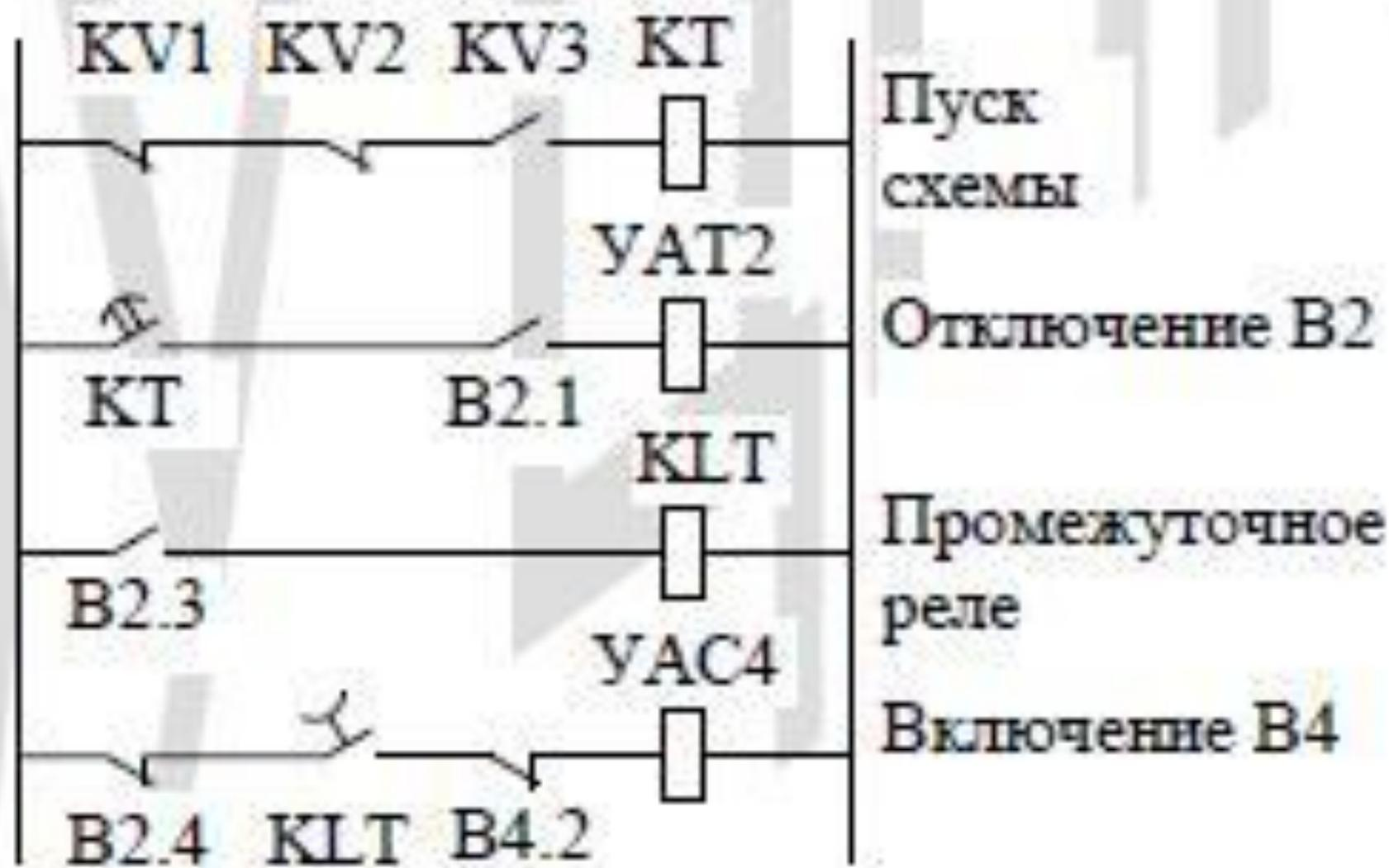
Линия Л1 является рабочей. Линия Л2 в нормальном режиме не работает и находится в резерве. Соответственно выключатели В1, В2 и В включены, а выключатель В4 отключен.
