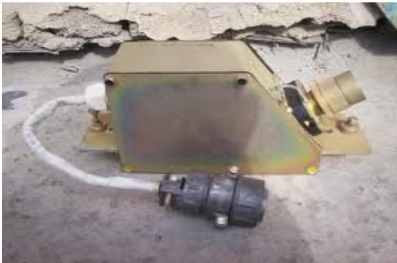
**ДИСК** – диагностическая информационная система контроля. Используется с целью повышения безопасности движения, качества подготовки состава и контроля технического состояния ПС на ходу поезда.
