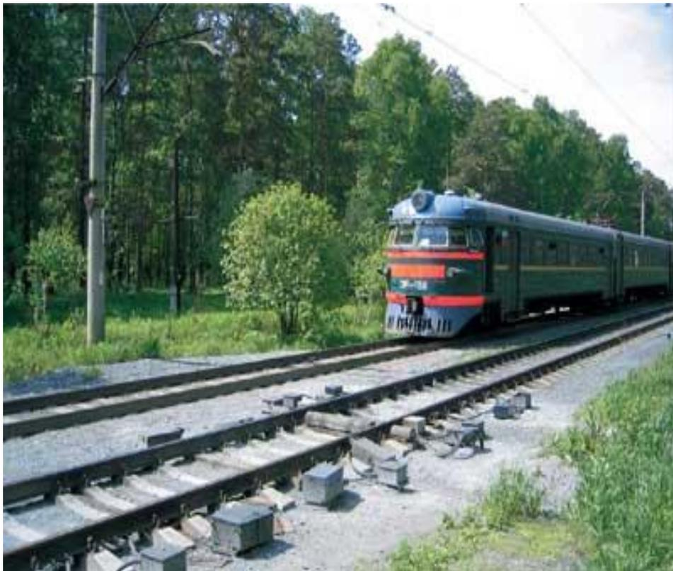
**ПОНАБ** («прибор обнаружения нагретых брукс», «пункт обнаружения нагрева аварийных брукс») — автоматический прибор для обнаружения нагретых брукс (угрожающих разрушением или пожаром) на железной дороге.
