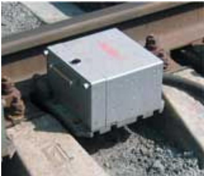
Прибор устанавливается около железнодорожного пути перед станцией и сообщает номера вагонов с перегретыми буксами в диспетчерскую станции; эта информация используется осмотрщиками вагонов после остановки поезда. Включается световой указатель в виде символа «V» прозрачно-белого цвета, установленный далее по пути следования поезда, сообщающий локомотивной бригаде о наличии перегретых букс в составе.
