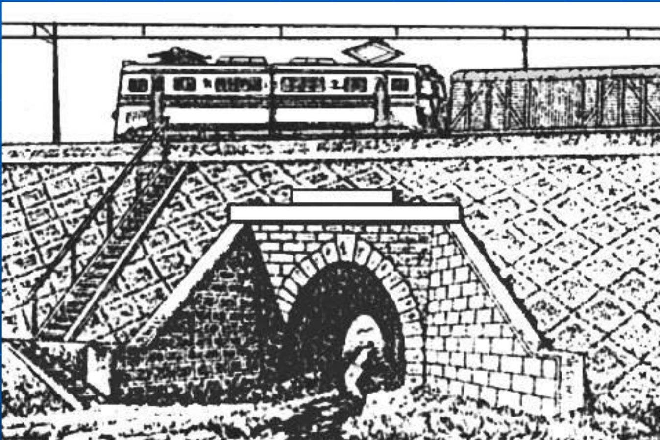
**трубы**, укладываемые под насыпями на небольших водотоках и суходолах для пропуска ливневых и снеговых вод.
