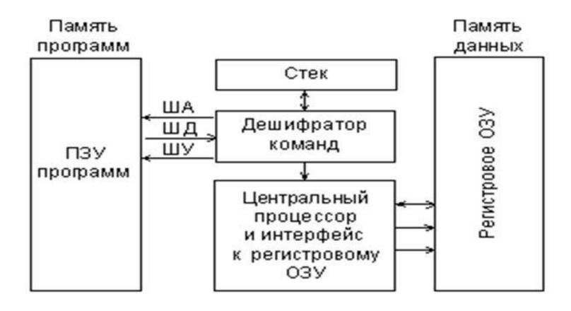
• В ЭВМ с использованием гарвардской архитектуры процессор может считывать очередную команду и оперировать памятью данных одновременно и без использования кэшпамяти.
