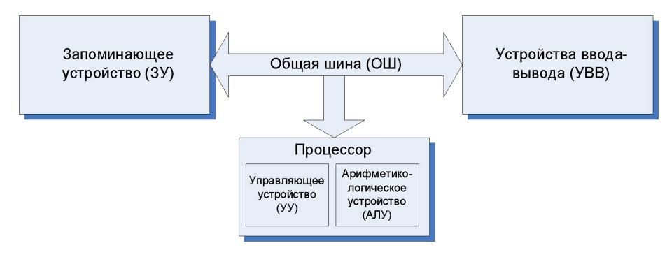
**Шины** имеют различное назначение и в общем виде их можно условно разделить на три – *шины* данных (ШД), шины адреса (ША), шины управления (ШУ). 23
