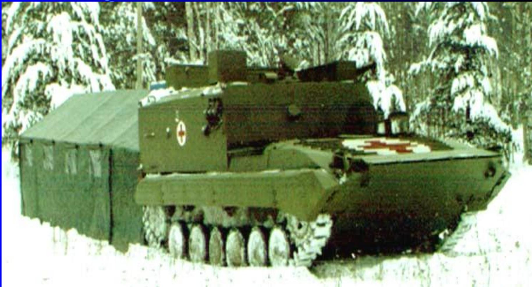
**Бронированная медицинская машина БММ-П на базе БМП-1.**
