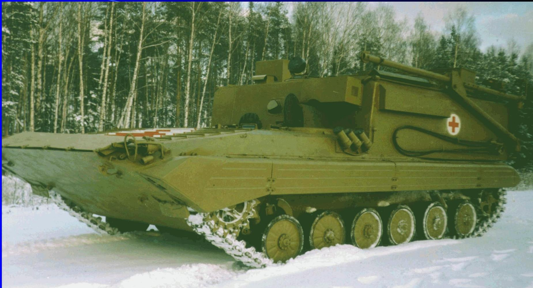
**Бронированная медицинская машина БММ на базе БМП-1.**
