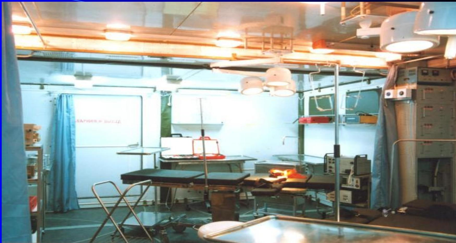
**Операционная на базе кузова-контейнера переменного объема. Предназначена для оказания квалифицированной хирургической помощи раненым и пострадавшим в полевых условиях. Размещается на шасси автомобиля КамАЗ-43101 .**
