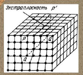
Пластический сдвиг является следствием постепенного перемещения дислокаций плоскости сдвига. Распространение скольжения скольжения происходит ПЛОСКОСТИ ПО последовательно. Каждый элементарный акт перемещения дислокации из одного положения в другое совершается путем разрыва лишь одной атомной вертикальной плоскости. перемещения дислокаций требуется значительно
