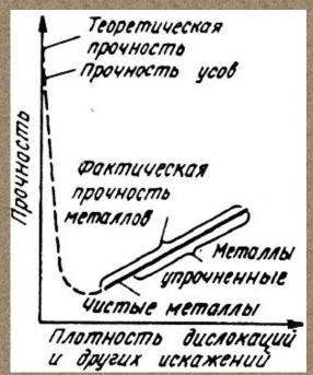
Левая ветвь кривой соответствует созданию совершенных бездислокационных нитевидных кристаллов (так называемых «усов»), прочность которых близка к теоретической. При ограниченной плотности дислокаций и других искажений кристаллической решетки процесс сдвига происходит тем легче, чем больше дислокаций находится в объеме металла.
