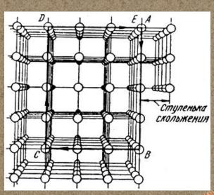
Винтовая дислокация. Образуется неполным сдвигом кристалла по плотности Q. В отличие от краевой дислокации винтовая дислокация параллельна вектору сдвига.
