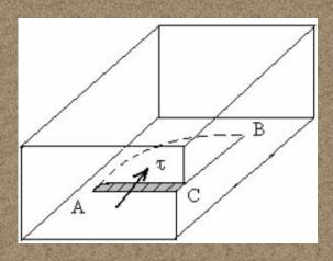
Пластическая деформация кристаллических тел связана с количеством дислокаций, их шириной, подвижностью, степенью взаимодействия с дефектами решетки и т. д. Характер связи между атомами влияет на пластичность кристаллов. Так, в неметаллах с их жесткими направленными связями дислокации очень узкие, они требуют больших напряжений для старта — в 10<sup>3</sup> раз больших, чем для металлов. В результате хрупкое разрушение в неметаллах наступает раньше, чем сдвиг.
