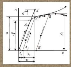
Эффект Баушингера явно проявляется при незначительном начальном Низкий наклепе. ОТПУСК наклепанных материалов ликвидирует все проявления эффекта Баушингера. Эффект значительно ослабляется при многократных циклических нагружениях материала наличием малых пластических деформаций
