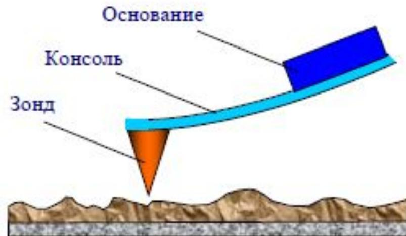
**Схематическое изображение зондового датчика АСМ**
