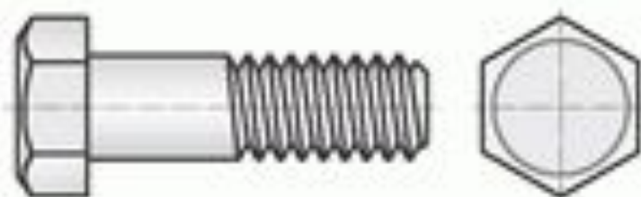
Болт с шестигранной головкой общего назначения
