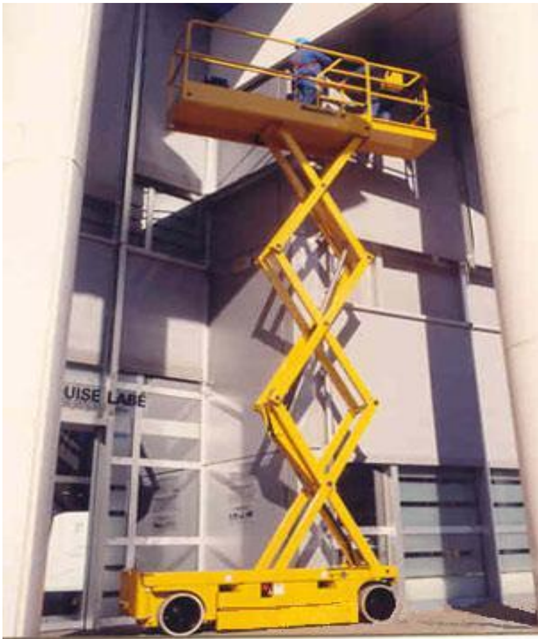
Рис. 15. Платформа для работы на высоте до 15 м
