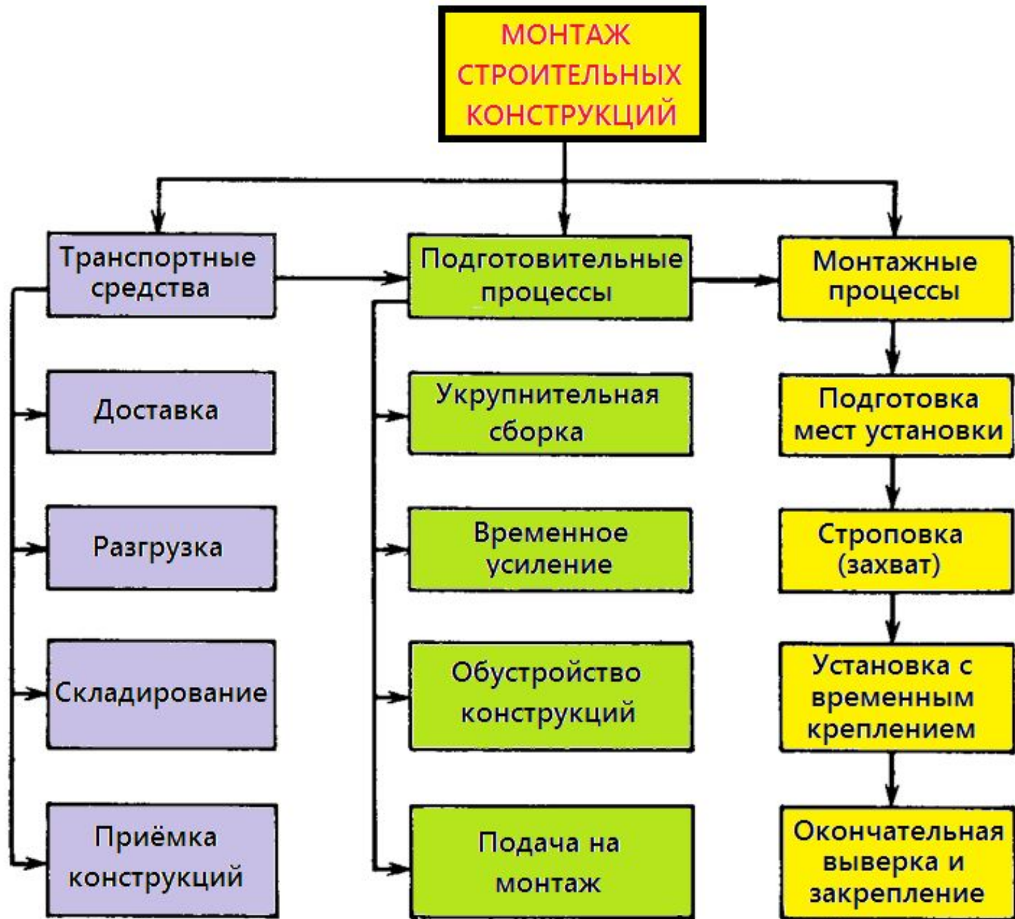
Рис. 1. Схема технологического процесса монтажа строительных конструкций
