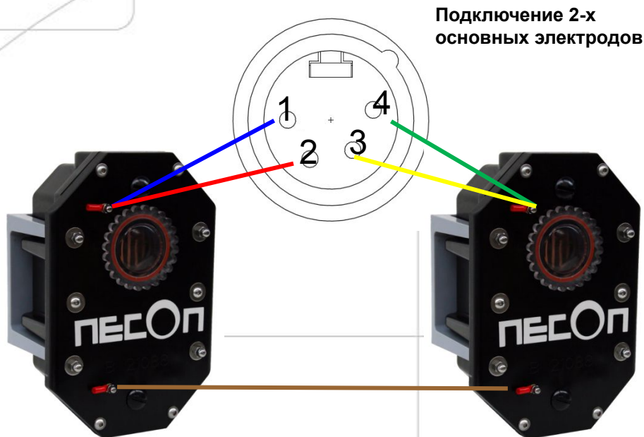
На рис. Показано соединение 2-х электродов MAXI-Combi (NEC-5010.3)
