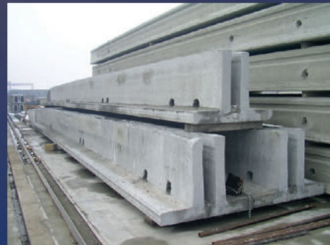
Плиты покрытия (перекрытия) высотой 1000 мм с видимой преднапряженной арматурой и поперечной стальной арматурной сеткой
