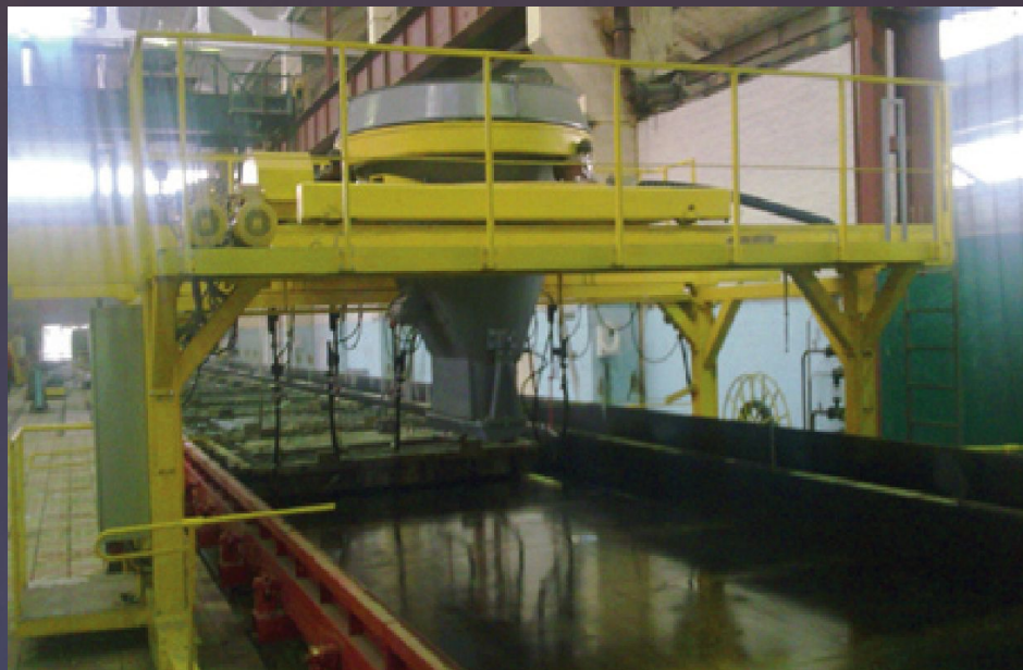
Бетоноукладчик на универсальном стенде
