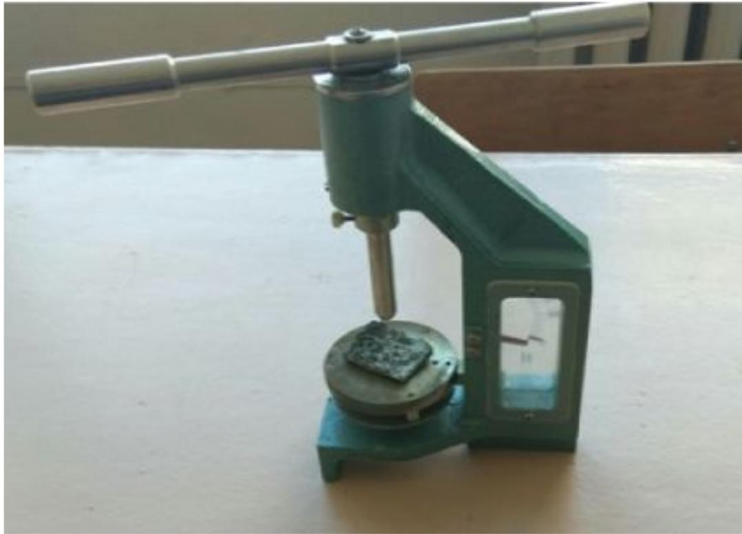
Прибор для определения механических свойств материалов ПИМ (учебный)
