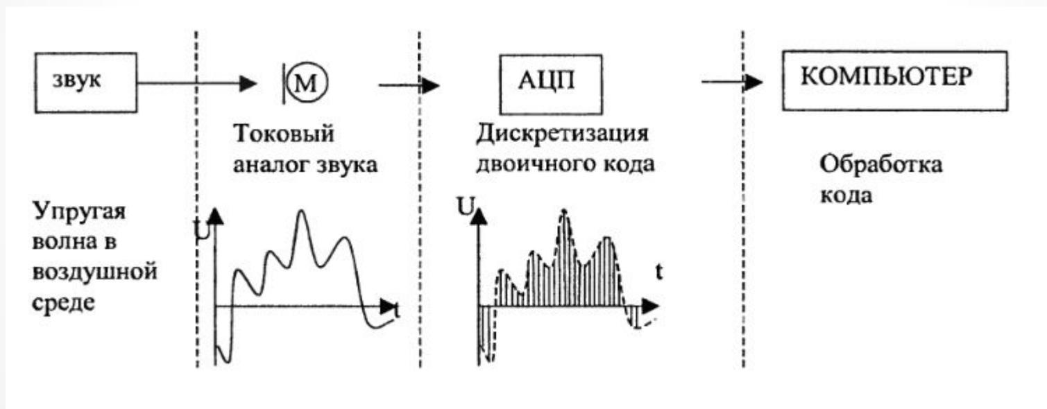
Звуковой сигнал преобразовывают в электрический аналог звука с помощью микрофона. Электрический аналог получается в непрерывной форме.
