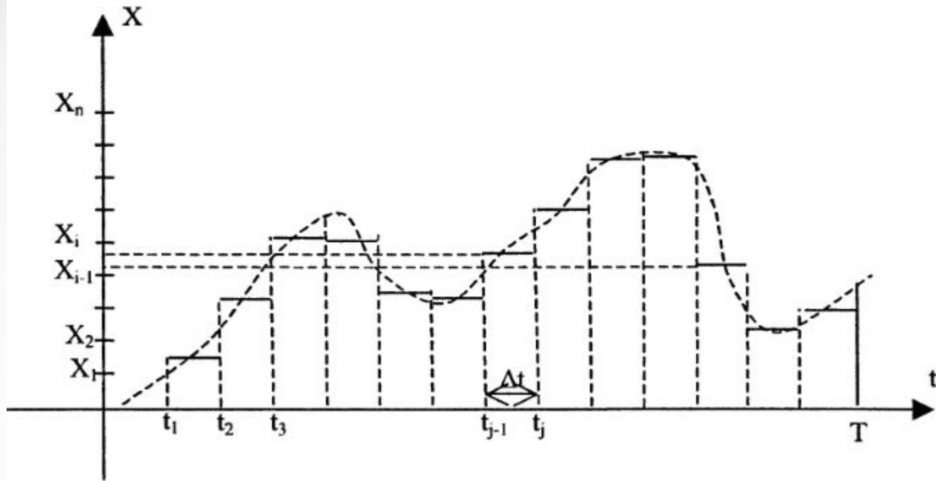
**Дискретизация по уровню** (квантование) – преобразование измеренного значения сигнала в целое число. Область изменения сигнала от самого малого значения до самого большого разбивается на  $N$  равных квантов. Каждый квант связывается с его порядковым номером, т.е. целым числом.
