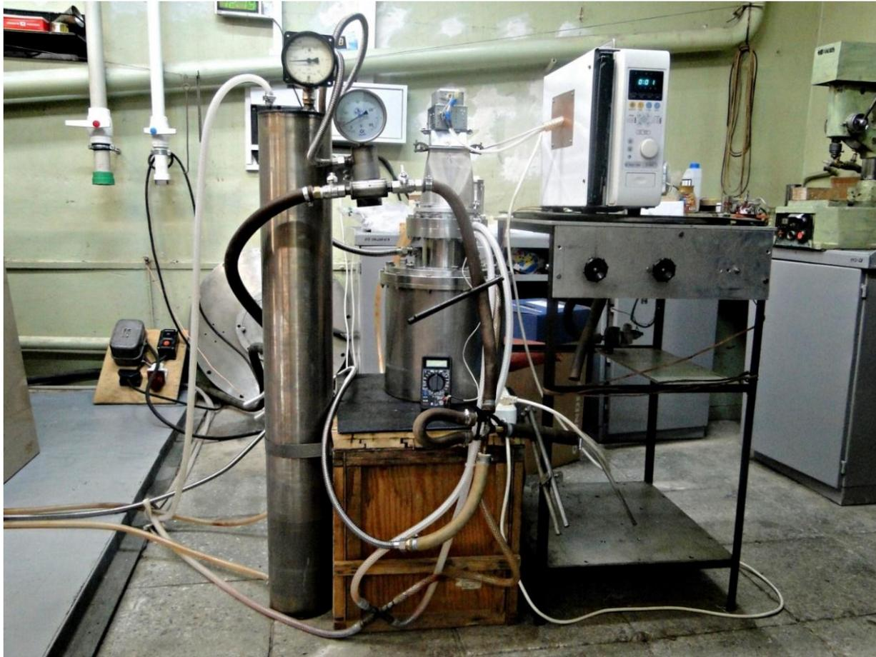
«1» - промышленный магнетрон; «2» - система сетевого питания; «3» - система воздушного охлаждения; «4» - согласующие волноводные элементы; «5» - барьерное окно; «6» - волновод связи; «7» - корпус реактора; «8» - система водного охлаждения; «9» - термopара; «10» - манометр; «11» - контейнер для топлива; «12» - выходной газовый клапан с механическим затвором; «13» - теплообменник.
