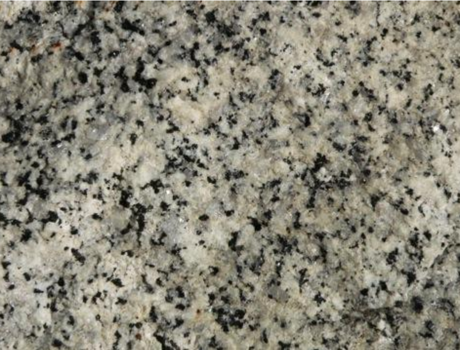
Granito: quarzo, feldspato alcalino, plagioclasio, biotite
