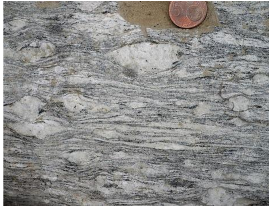
Ortogneiss: tessitura anisotropa costituita da livelli micacei e livelli quarzoso-feldspatici
