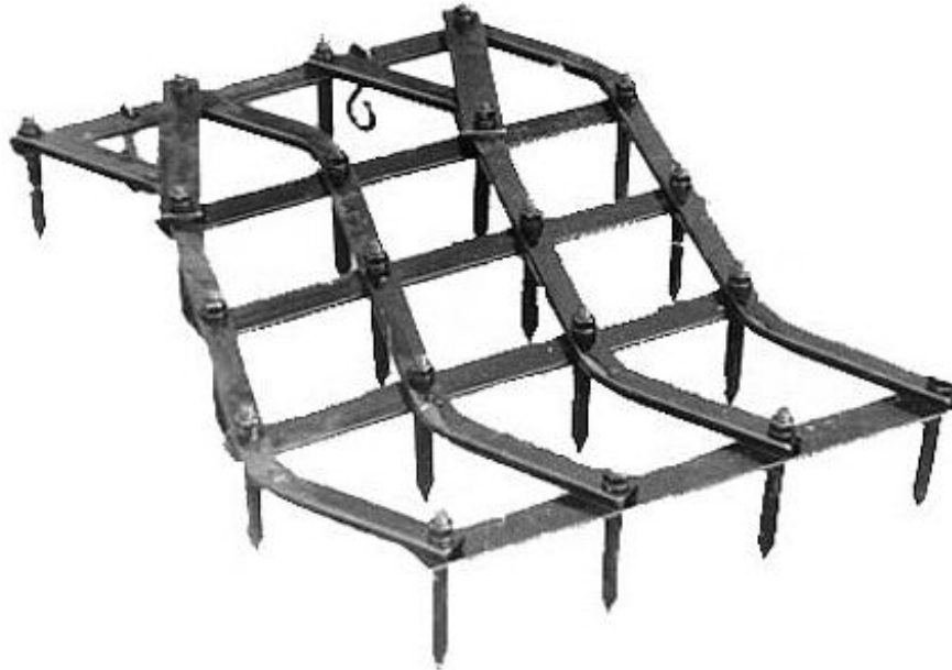
Рисунок 5.2 – Звено зубовой бороны типа «зигзаг»
