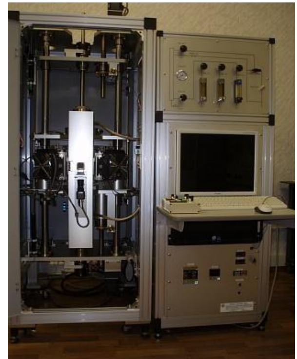
Рисунок 4 - установка для выращивания монокристаллов методом зонной плавки
