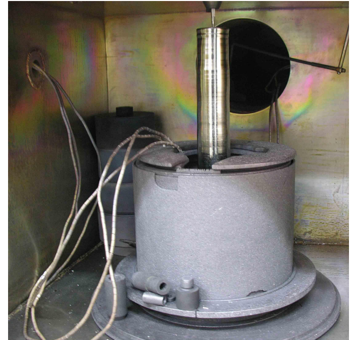
Рисунок 2 - установка для выращивания монокристаллов германия методом Чохральского
