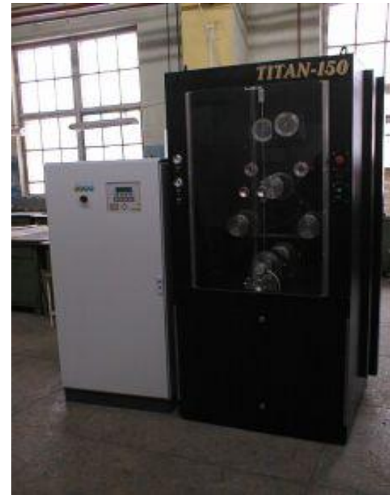
Рисунок 5 - установки для резки монокристаллов: слева - алмазным диском с режущей кромкой, справа - проволокой с применением абразива.
