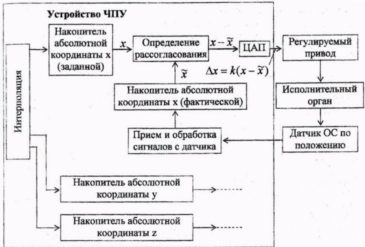
Схема отработки управляющих дискрет следящими приводами произвольного типа
