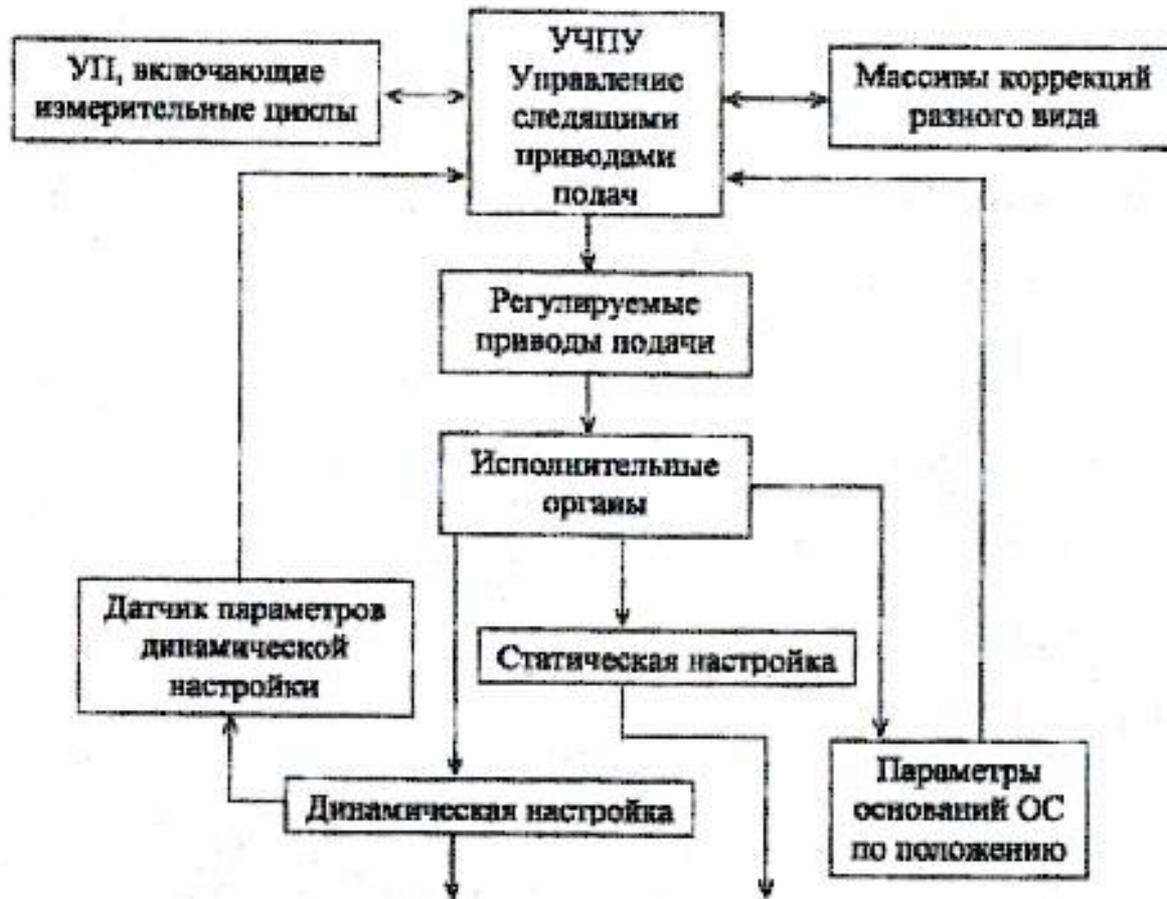
. Схема решения ТхЗ ЧПУ, связанной с управлением качеством обработки
