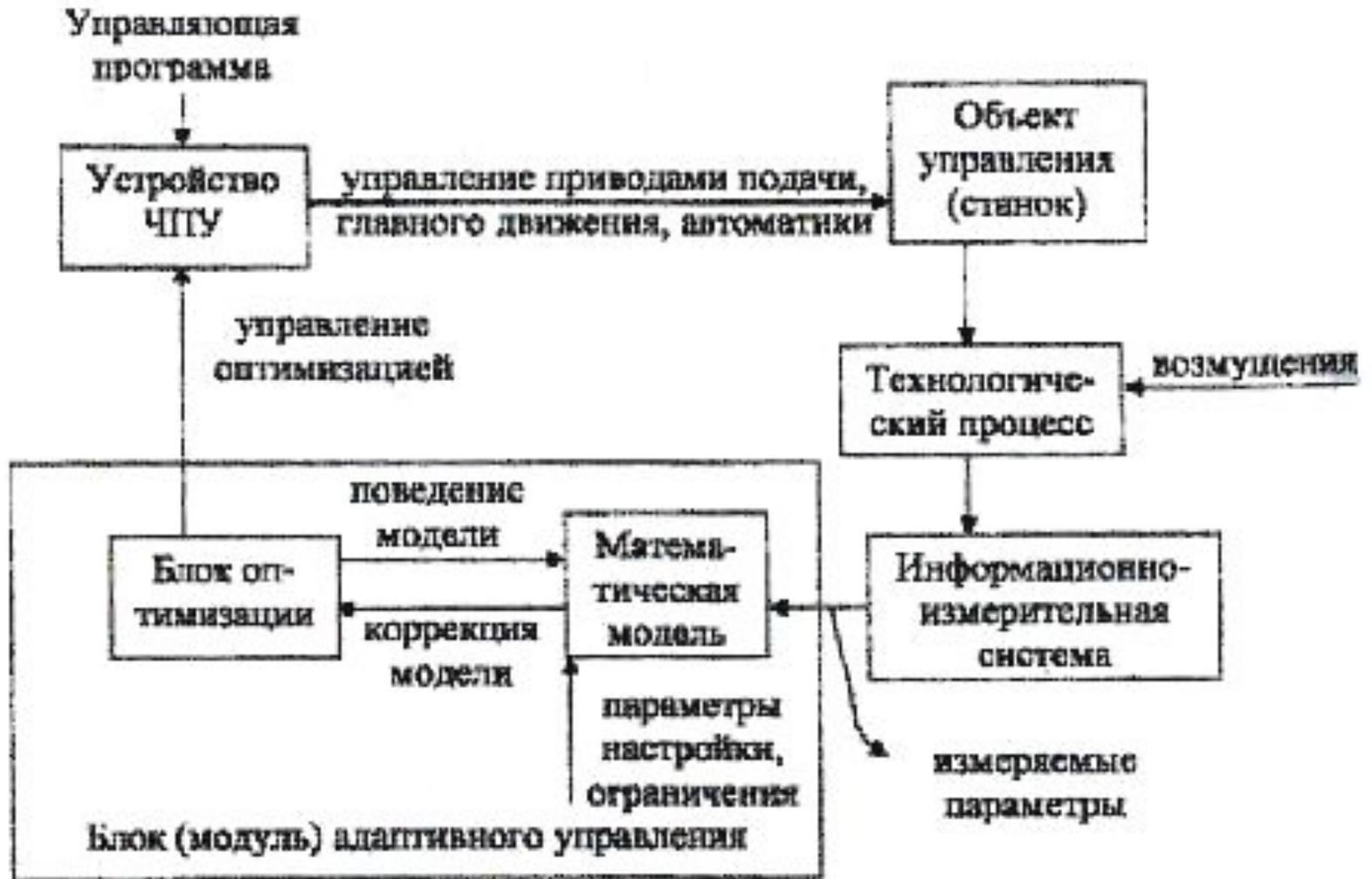
Обобщенная структурная схема системы адаптивного упр
