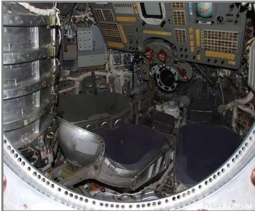
В главном отсеке космонавты стартуют с Земли. Отсюда они управляют кораблём, связываются с Землёй по радио. Это единственная часть корабля, которая возвращается на Землю.
