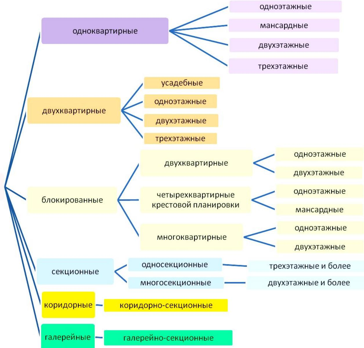
Рисунок – Типологическая схема жилых домов по объемно-планировочной структуре
