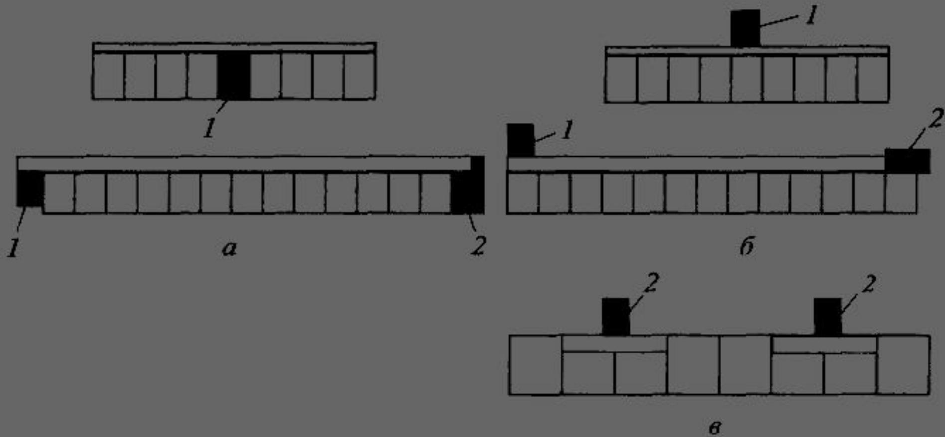
Рисунок – Схемы планов галерейных домов: а – лестницы расположены в габарите дома; б – лестницы вынесены за габариты дома; в – галерейно-секционный дом
