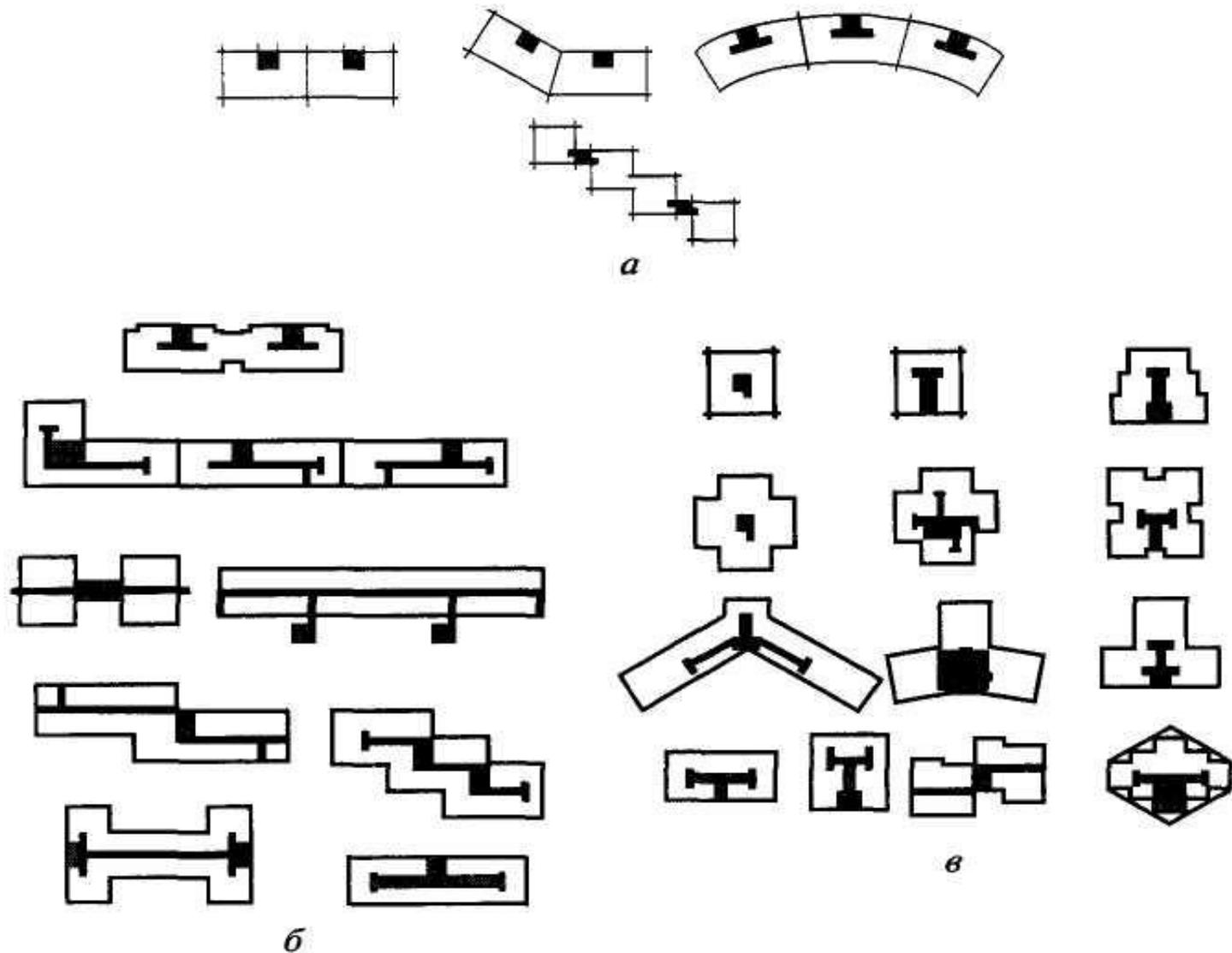
Рисунок – Композиционные схемы планов многоэтажных секционных домов:
