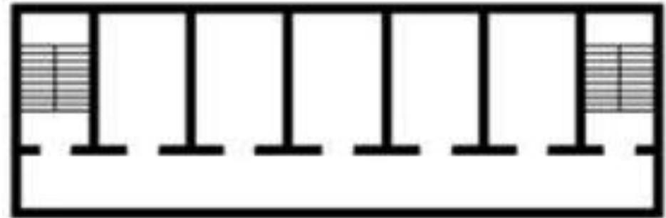
Рисунок – Ячейковая планировочная схема
