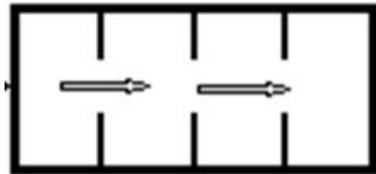
Рисунок – Анфиладная планировочная схема
