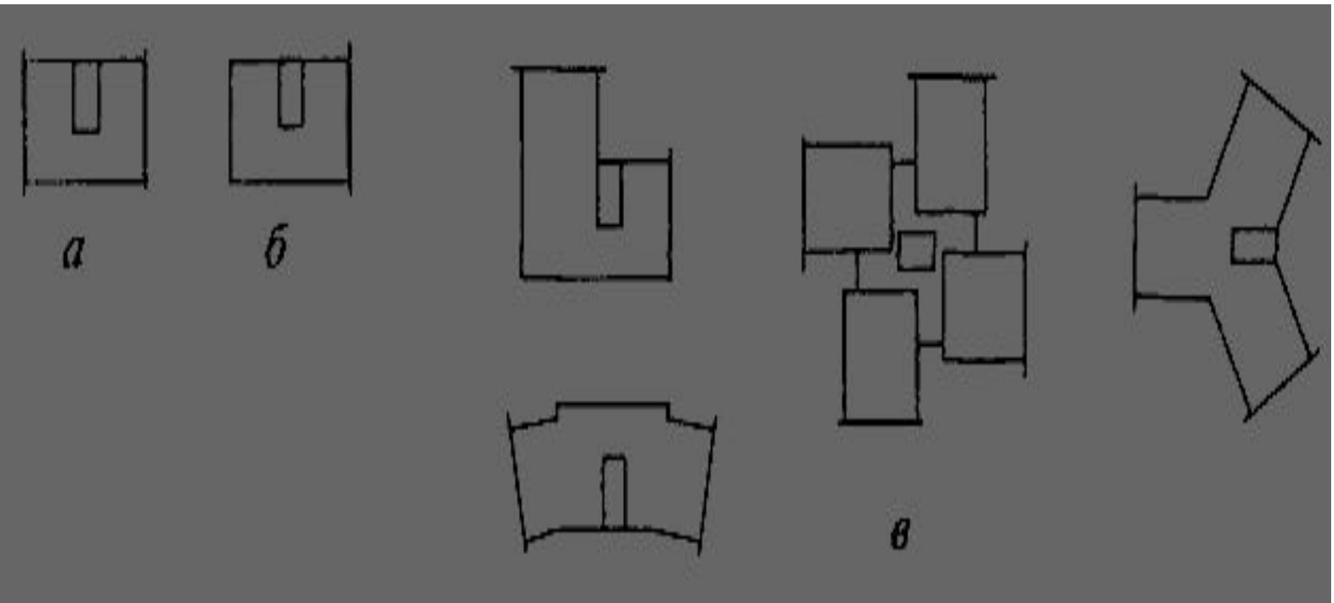
Типы секций в соответствии с местом их расположения на плане: а – рядовая; б – торцевая; в - поворотные
