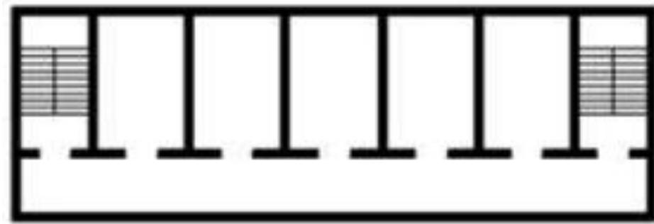
Рисунок – Ячейковая планировочная схема
