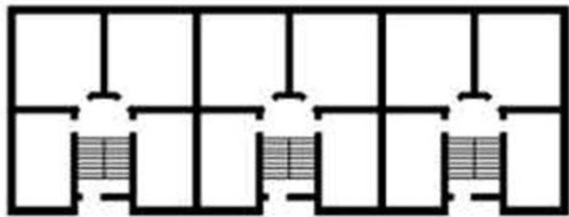
Рисунок – Секционная планировочная схема
