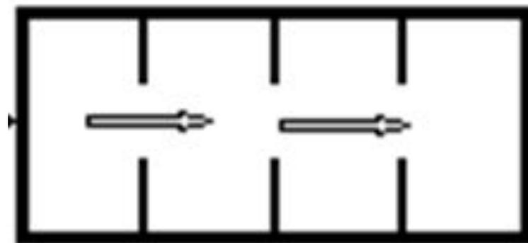
Рисунок – Анфиладная планировочная схема
