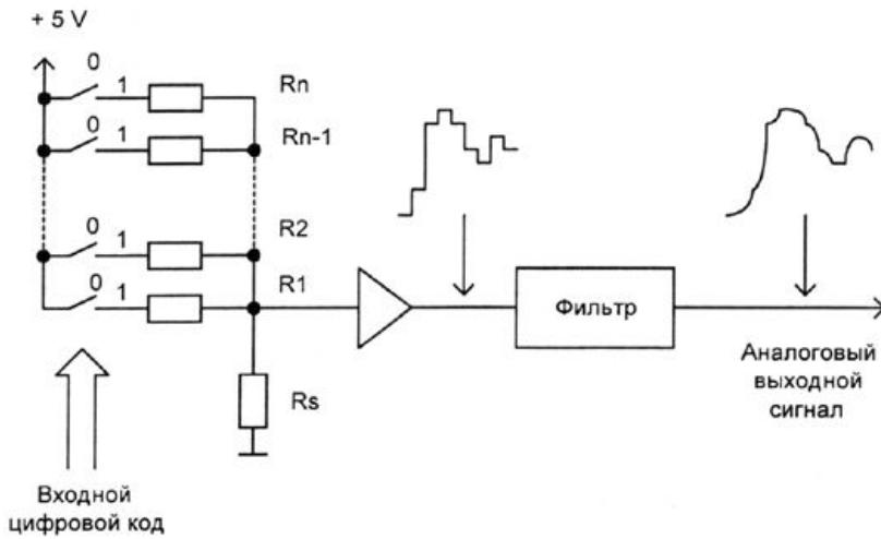
Посмотрите на рис., где показан принцип цифроаналогового преобразования. Входной цифровой код поступает на вход ЦАП. Каждый разряд кода управляет выключателем, который подает на вход усилителя напряжение (ток) своего уровня. Суммарное напряжение на выходе усилителя представляет собой ступенчатый сигнал. После сглаживания выходного сигнала с помощью фильтра на выходе ЦАП появляется выходной аналоговый сигнал, который в точности соответствует тому, который был закодирован в цифровом коде.
