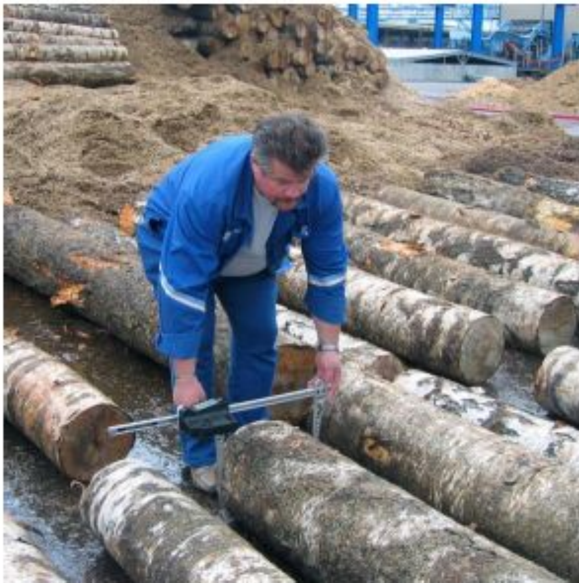
Измерение верхнего диаметра электронной лесной вилкой
