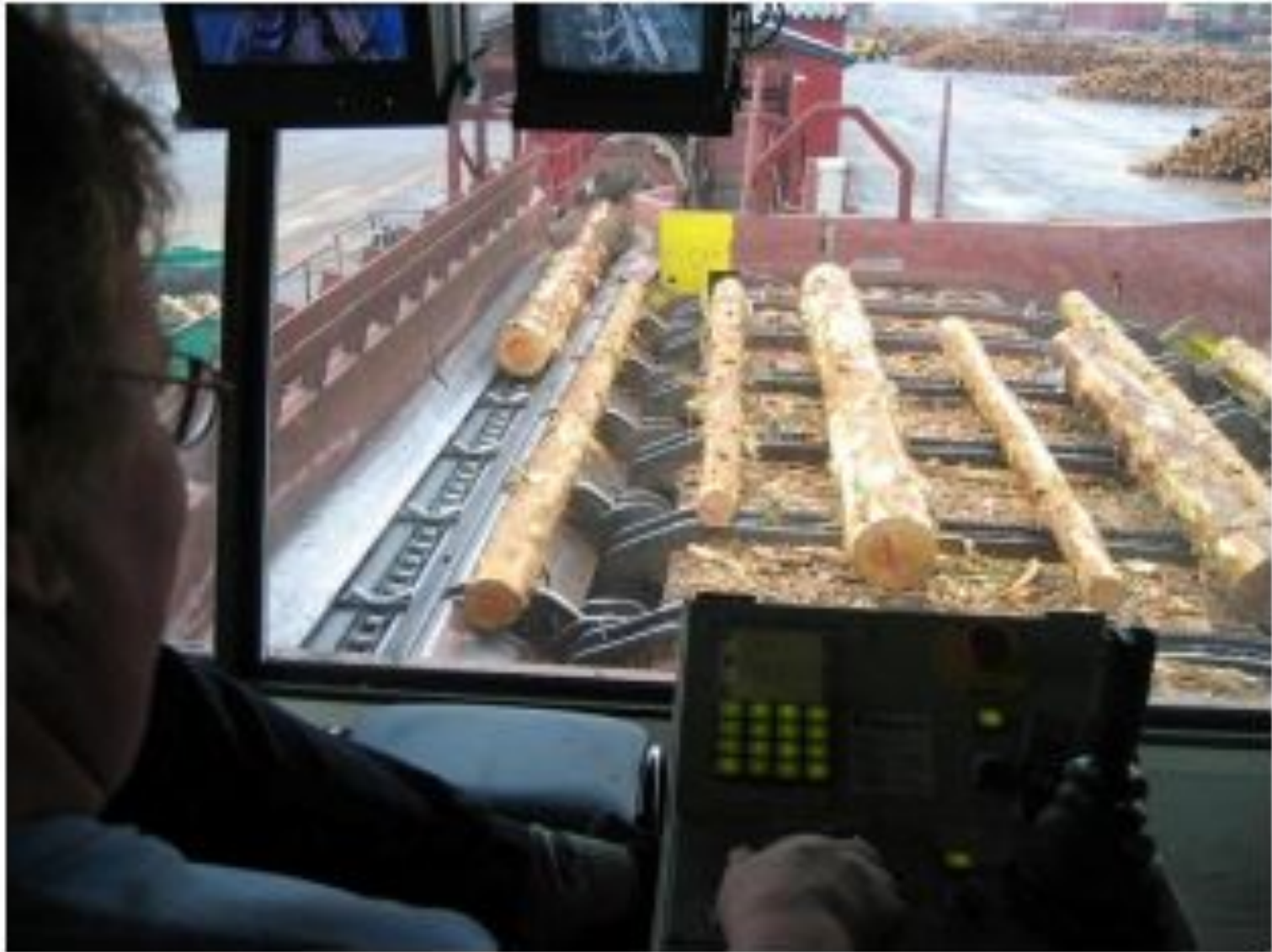
Вид с рабочего места оператора линии учета и сортировки пиловочника
