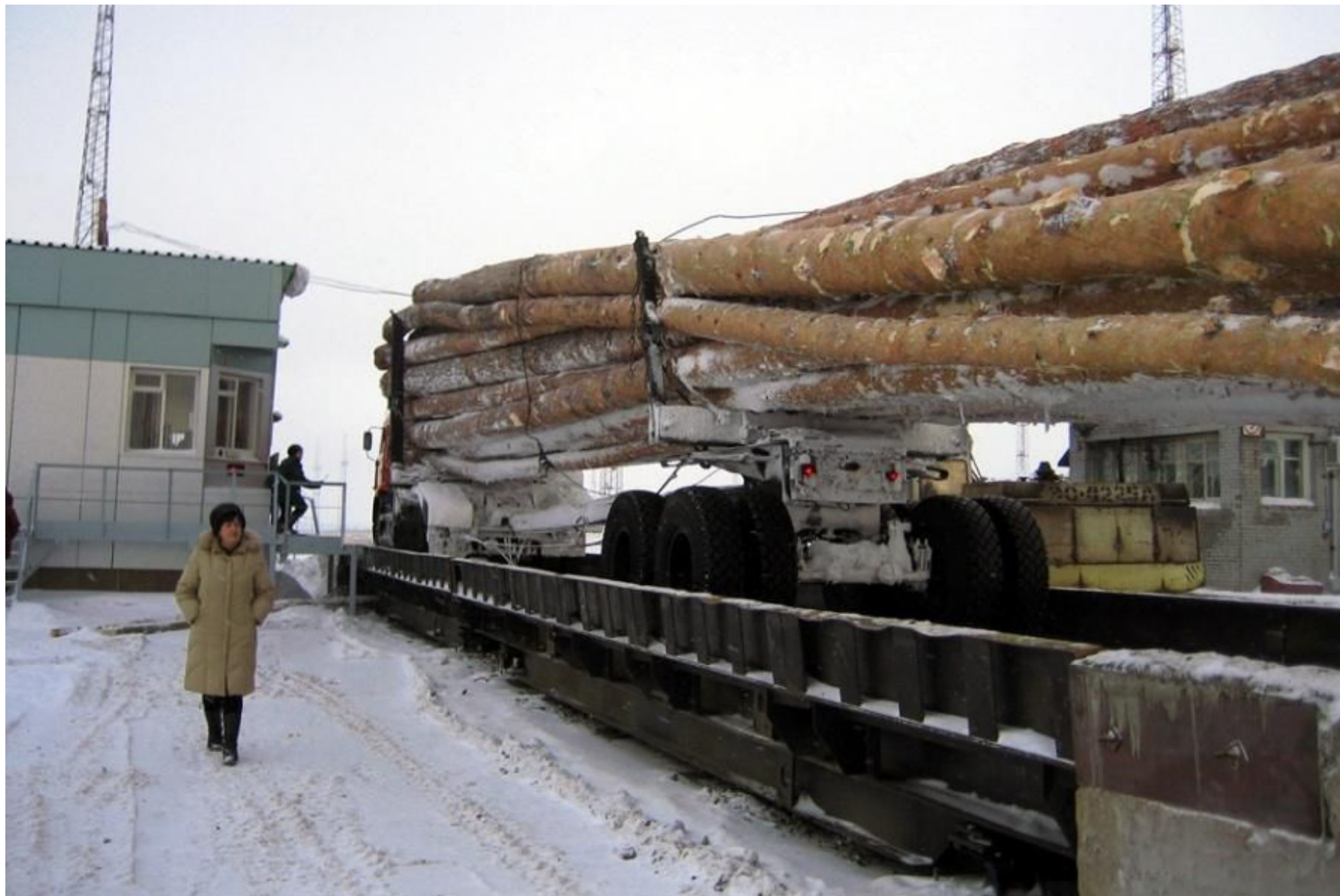
г. Усть-Илимск. Приемка хлыстов с измерением объема весовым методом
