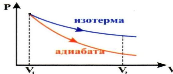
Здесь уместно рассмотреть еще и **политропный процесс** – такой процесс, при котором изменяются все основные параметры системы, кроме теплоемкости, т.е.  $C = \text{const}$ .
