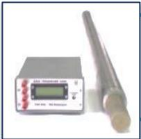
Инклинометр скважинный электронный «СИЭЛ»
