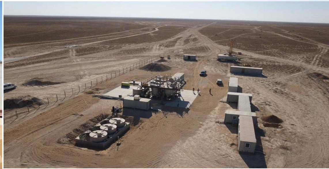
Предназначен для отработки небольших геологических залежей, находящихся на большом удалении от перерабатывающей установки.
