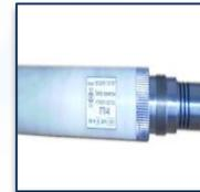
Прибор термометрии и токового каротажа «ПТТК-40»
