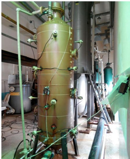
УЗ излучатели с генератором новой конструкции на колонне СНК 1700
