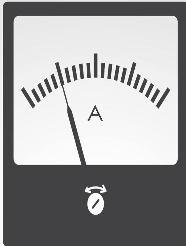
Амперметр прибор для измерения силы тока
