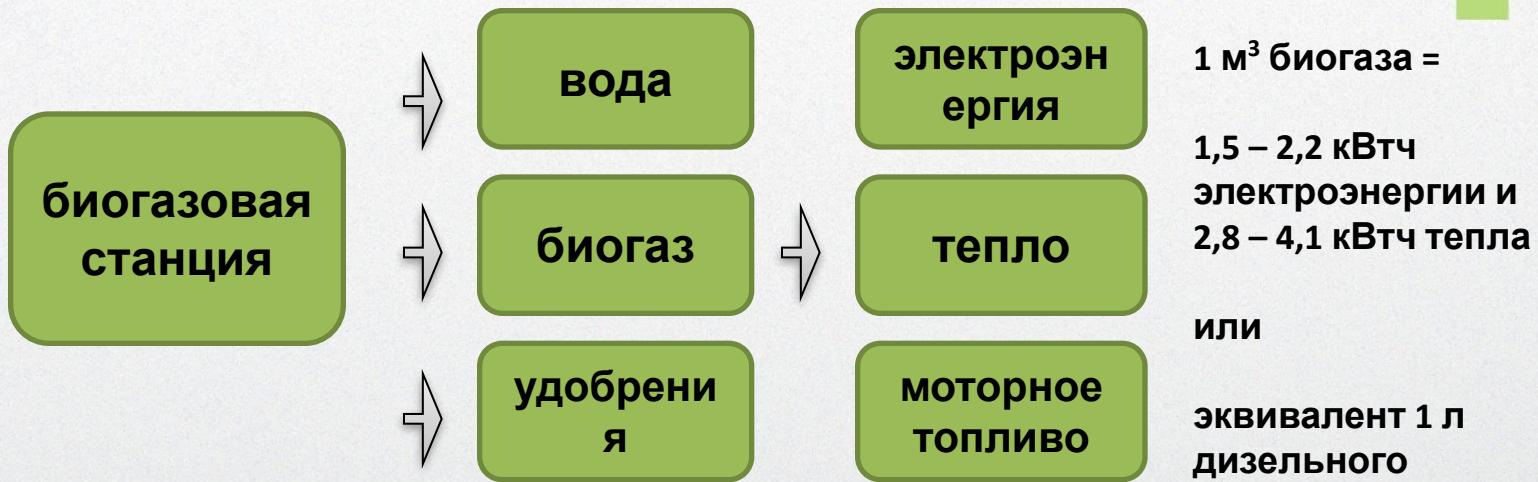
Конечную продукцию биогазовой станции составляют: тепло, электроэнергия, сжиженный газ, удобрения, чистая вода и углекислый газ.
