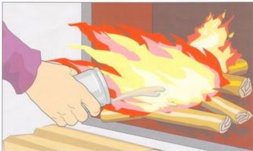
Применение для розжига печей легковоспламеняющихся и горючих жидкостей, выпадение углей, трещины в кладке, возгорание сажи в дымоходах
